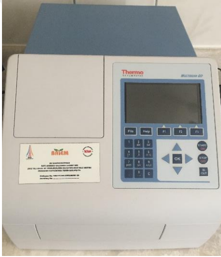
Şekil 3.4. DNA'nın kalitesini ve miktarını belirleyen spektrofotometre aleti
