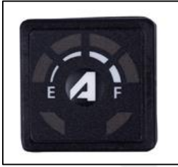
Resim 5.12. Yakıt seçici anahtar ve seviye göstergesi
