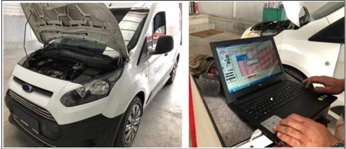
Resim 5.15. Dizek - LPG dönüşümü sisteminin programlanması
