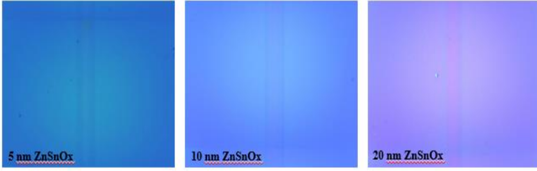
Şekil 6.21 : 5nm-10nm-20nm kalınlıkta ZnSnO x son katman kaplanmış Low-E kaplamalı cam üzerinde oluşturulan çiziklerin optik mikroskop görüntüleri.
