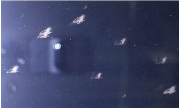
Şekil 4.5 : Low-E kaplamalı camlarda taşıma esnasında oluşan çizik hasarları.
