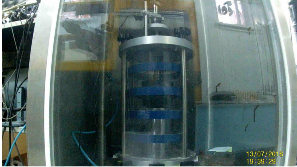
Şekil 4.12. Üç eksenli olarak ısıtmalı kabinde gerçekleştirilen deney
