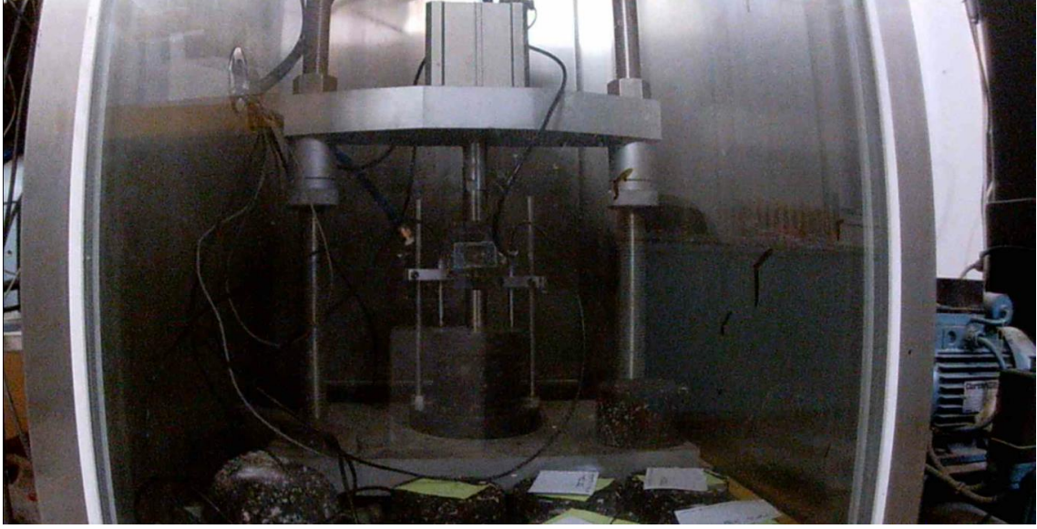
Şekil 4.7. Tek eksenli olarak ısıtmalı kabinde gerçekleştirilen deney
