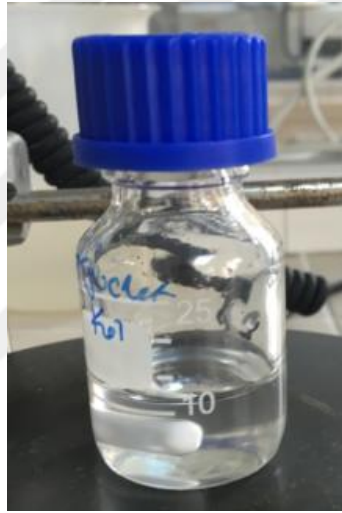
Şekil 3.2: %2 Tuvalet kağıdı %8’lik LiCl/DMAc çözeltisi.
