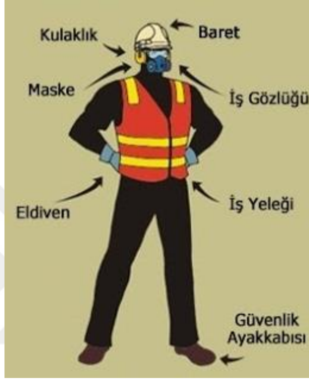
Şekil 3.4 Yapı alanlarında kullanılan kişisel koruyucu donanımlarına örnekler
