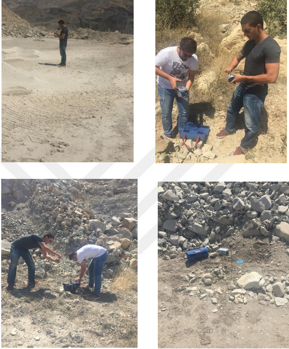
Şekil 6.13. Titreřim ölçüm cihazlarının yerleřtirilmesi ve patlatma sahasından görüntüler
