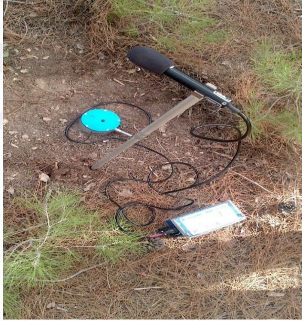
Şekil 5.4. Patlatma titreşimlerini ölçen cihaz, jeofon ve mikrofon
