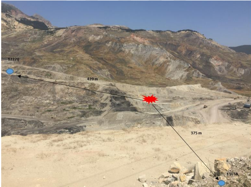
Şekil 6.2. A panosunda patlatma yapılan yer (kırmızı alev işareti) ve ölçüm cihazlarının (12270 ve 13638) bulunduğu noktalar (mavi yuvarlaklar)
