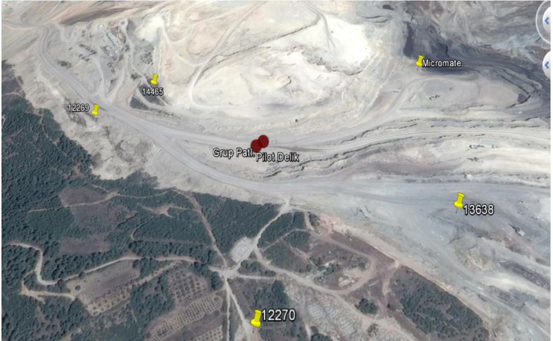
Şekil 6.12. Eynez Ocağında pilot ve grup patlatma yapılan yerler ve ölçüm cihazlarının (12270, 12269, 14465, 13638) bulunduğu noktaların Google Earth'den alınan görüntüleri [58]
