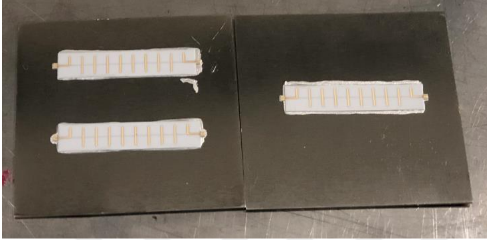
Resim 4.20. 3 adet aygıtın test için 2 kupona dizilmiş görüntüsü
