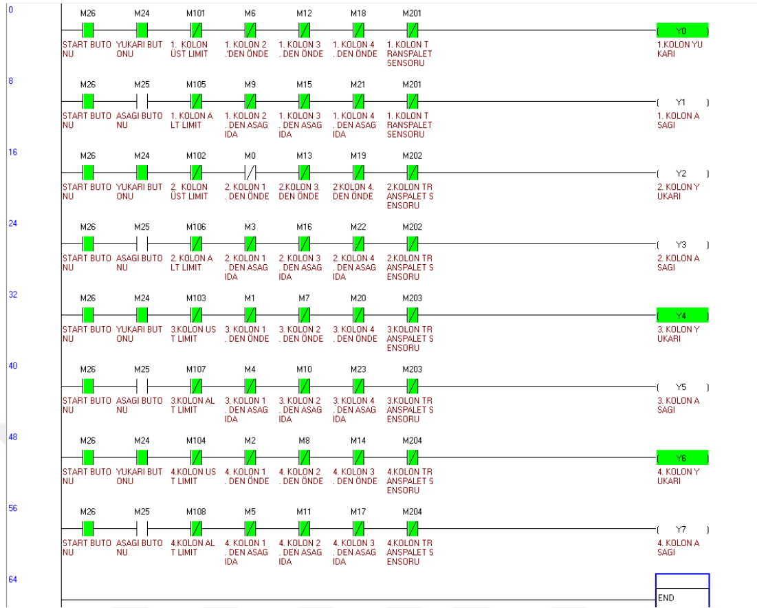
Şekil 3.38: PLC merdiven diyagramı-2.
