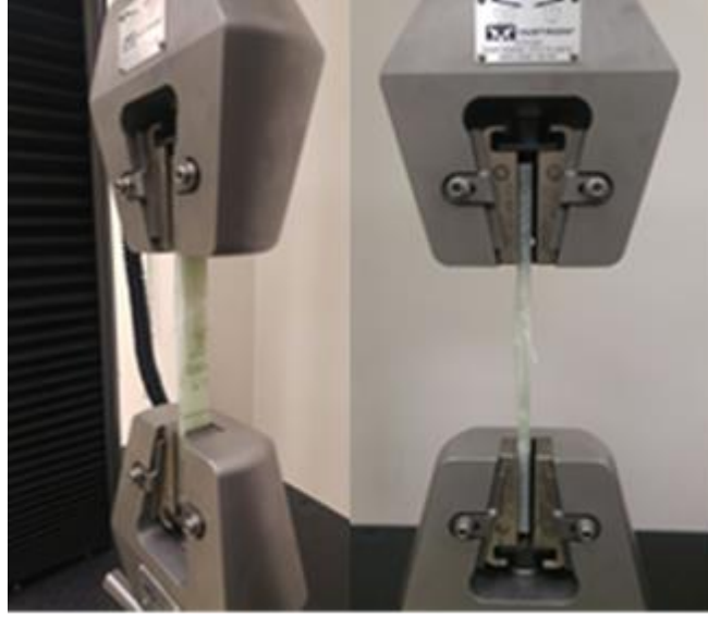
Şekil 27.Çekme testi test cihazı ve numune pozisyonu
