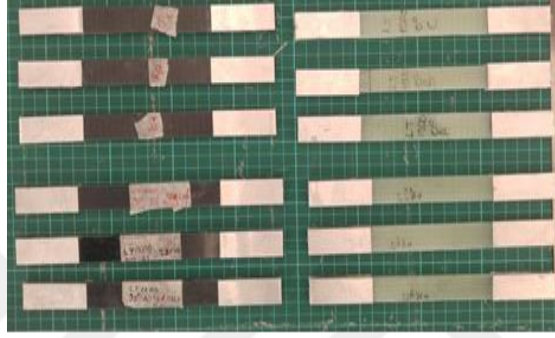
Şekil 30. Çekme numuneleri %0,2 CNT (solda) %0 CNT (sağda)
