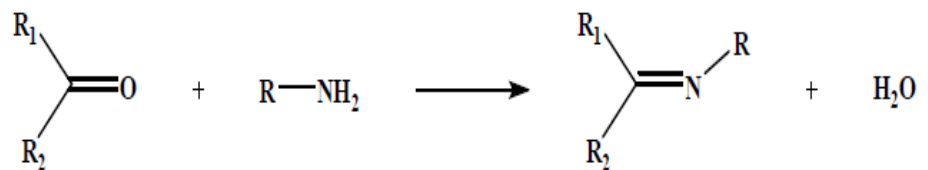
Şekil 1.3. Schiff bazı oluşum mekanizması [41]
