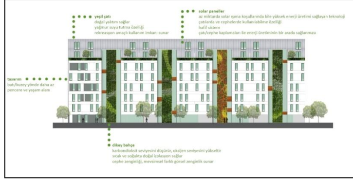
Şekil 4. 16 Barinkent Sitesi Bina Cepheleeri 1. alternatif
