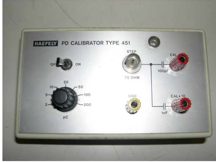
Şekil 4.4 : 100 pF – 1 nF arasında ayarlanabilen kuplaj kapasitörü.
