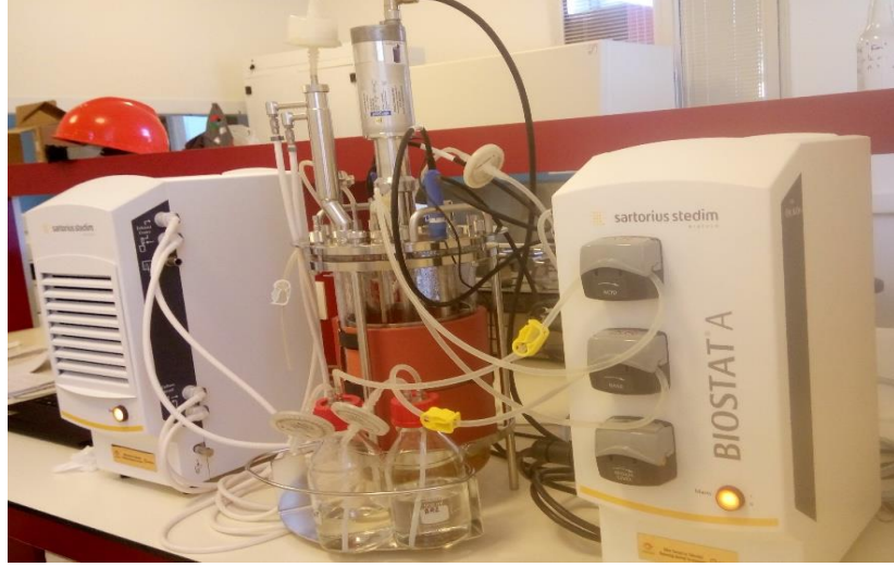
Şekil 3.1 Aşı kültürünün fermentörde üretimi
