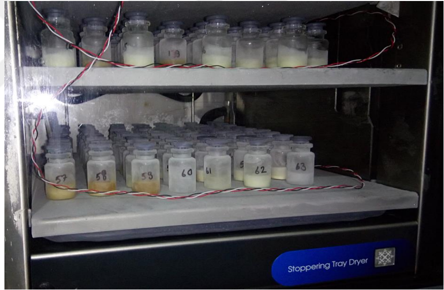
Şekil 3.2 Liyofilizasyon viallerinin liyofilizatör içindeki yerleşimi
