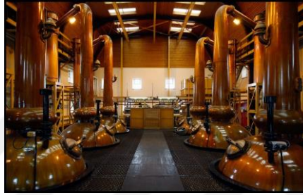
Resim 111 İçkilerin Damıtıldığı Bakır İmbikler (URL-161)
