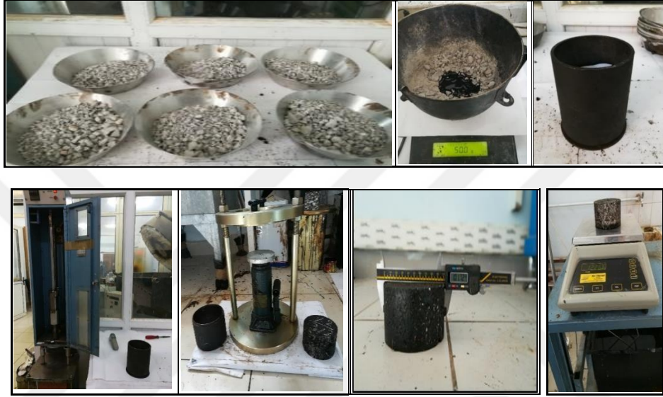
Şekil 4.19. Marshall deneyi (Yöntemi)
