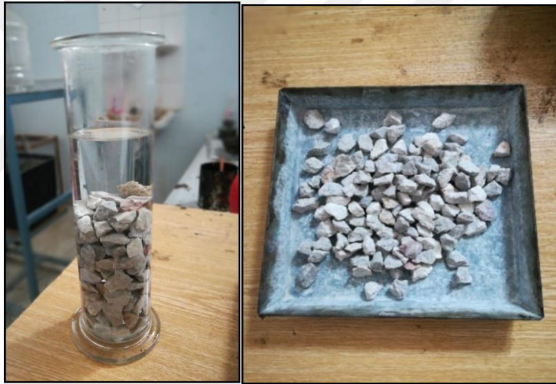
Şekil 4.11.Özgül ağırlık deneyi
