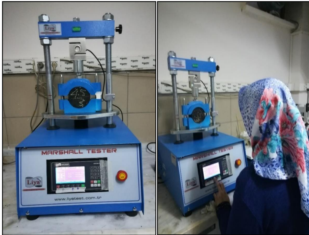
Şekil 4.23. Numunenin stabilite ve akma testi
