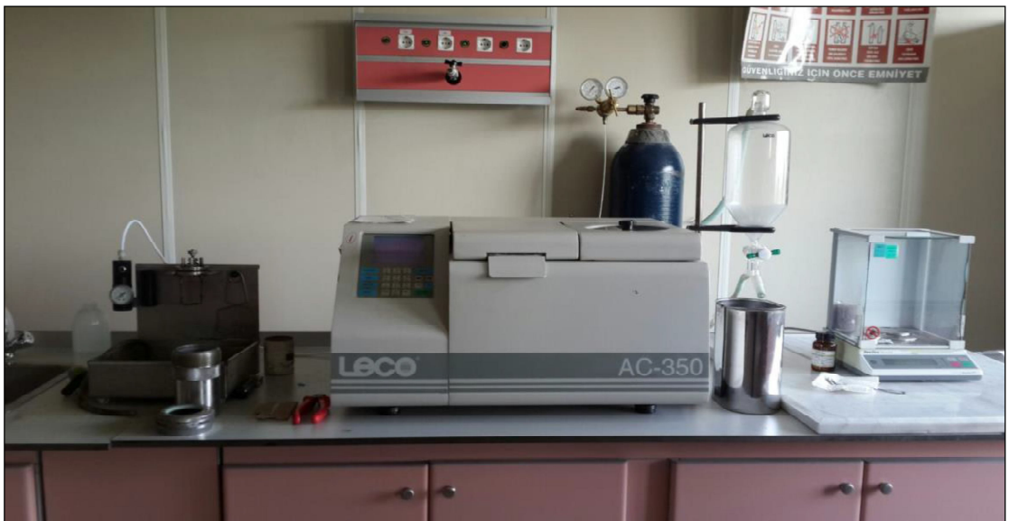
Şekil 4.7. Isıl değer tayini yapılan leco AC-350 model kalorimetre
