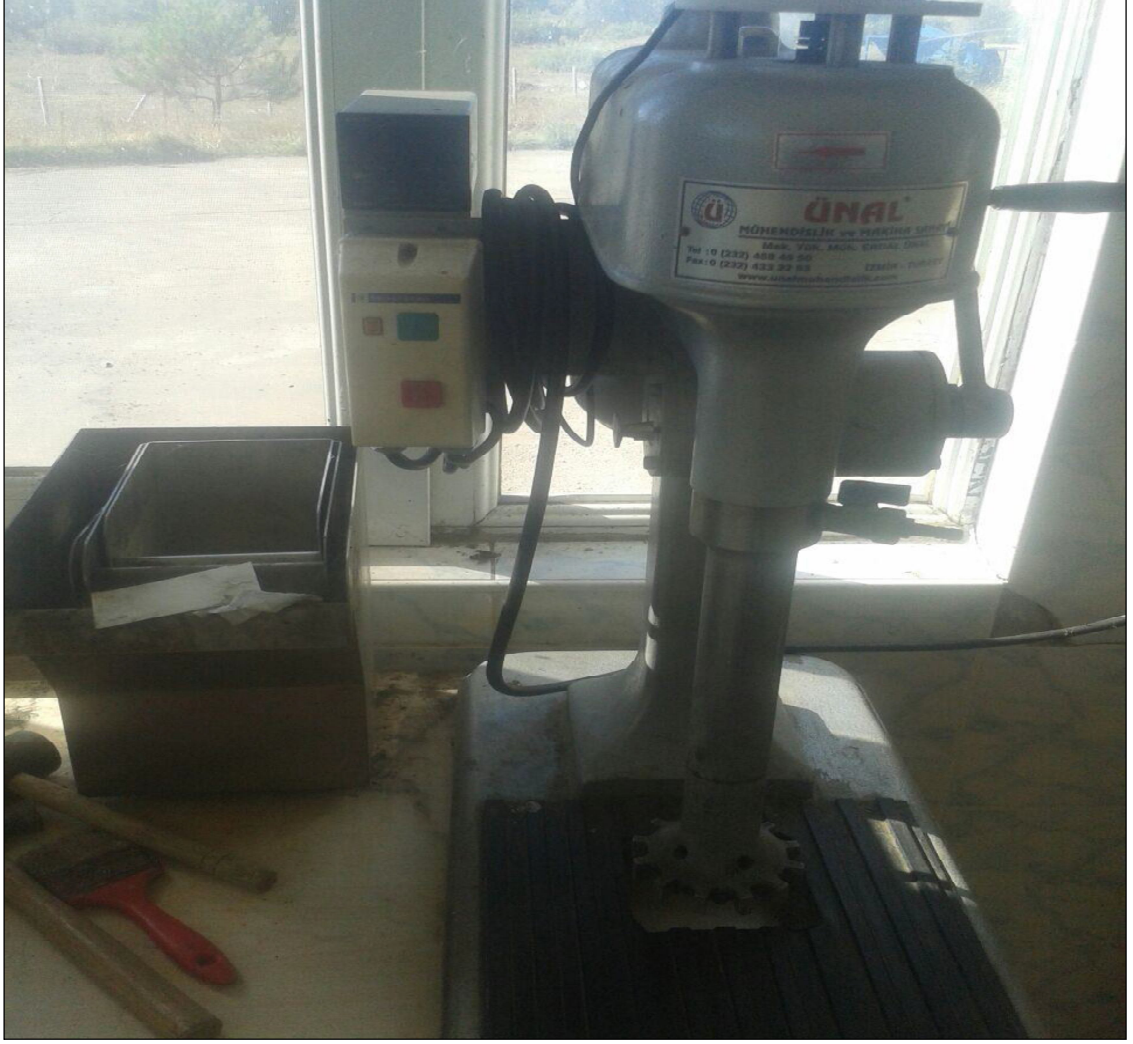
Şekil 4.5. Deneylerin yapıldığı flotasyon cihazı
