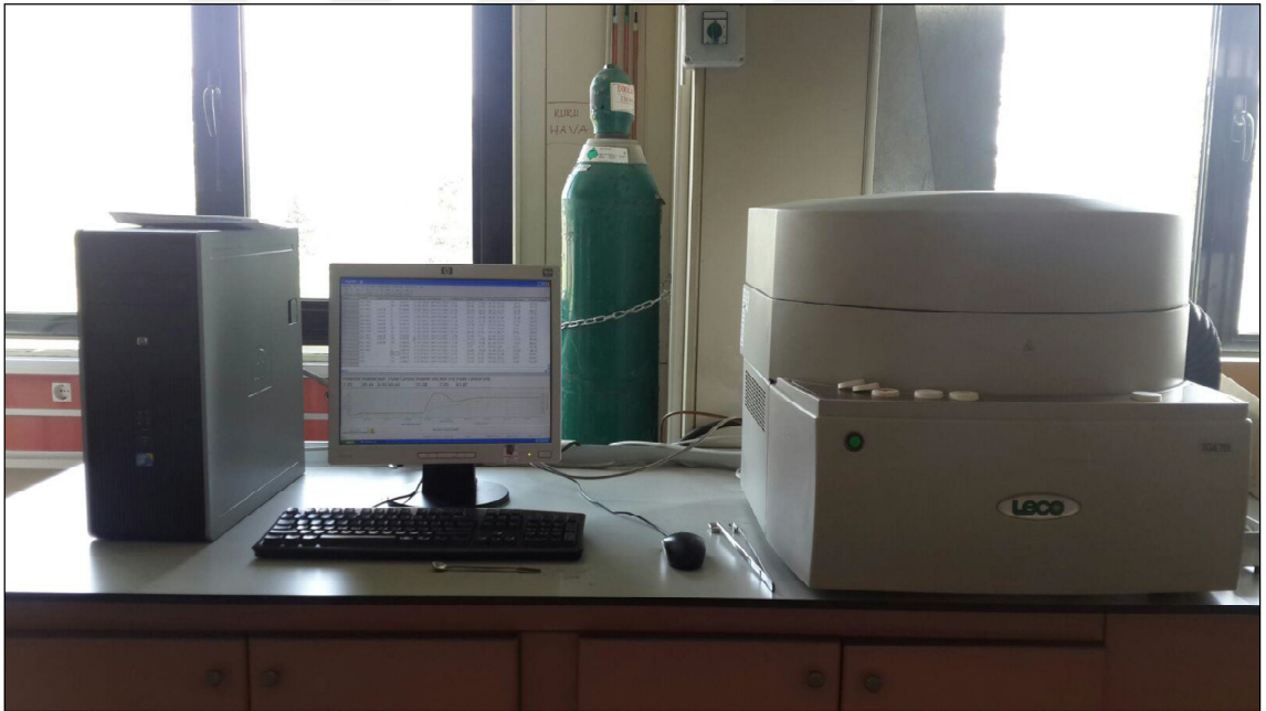
Şekil 4.8. Uçucu madde tayini yapılan leco TGA-701 model cihaz
