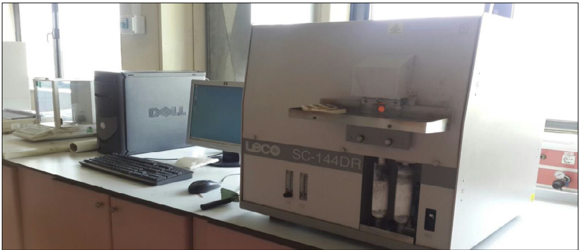
Şekil 4.9. Kükürt ve sabit karbon değerlerinin analizlerinin yapıldığı leco SC-144 DR model cihaz
