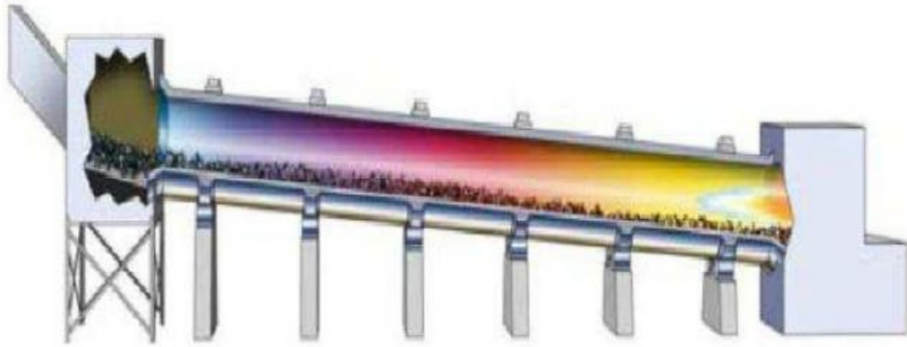
Şekil 2.4. Döner fırının ters akış prensibi (Altınkaynak, 2013).
