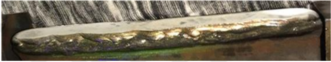
Şekil 5.4. Kaynak işlemi sonrası makas bıçağı.
