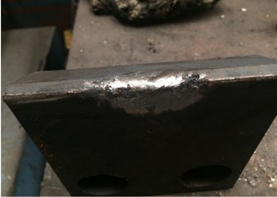
Şekil 5.1. Aşınmış makas bıçağı fotoğrafı.
