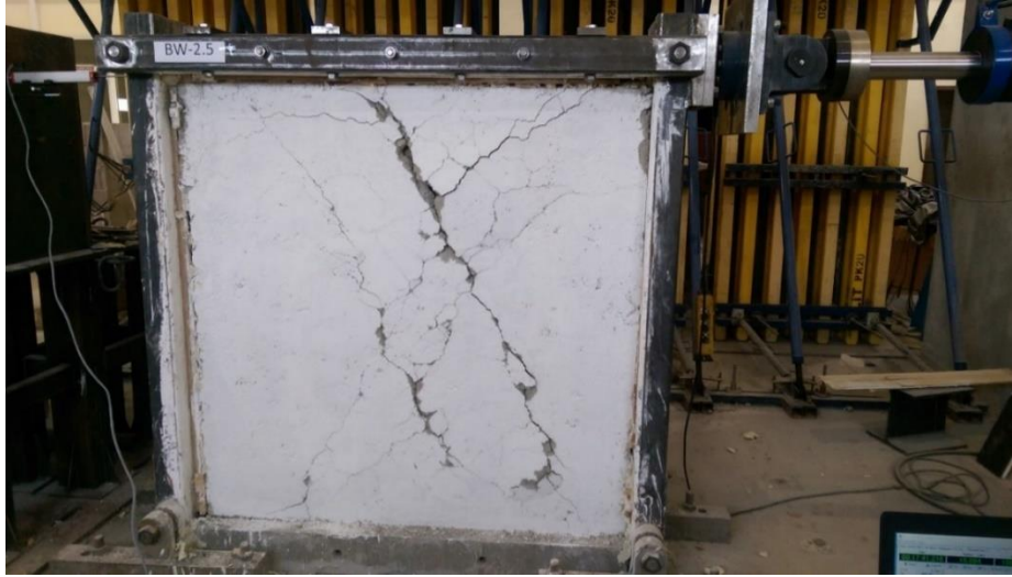
Şekil 4.13. BW-2.5 dolgu duvarının deney anı görüntüsü
