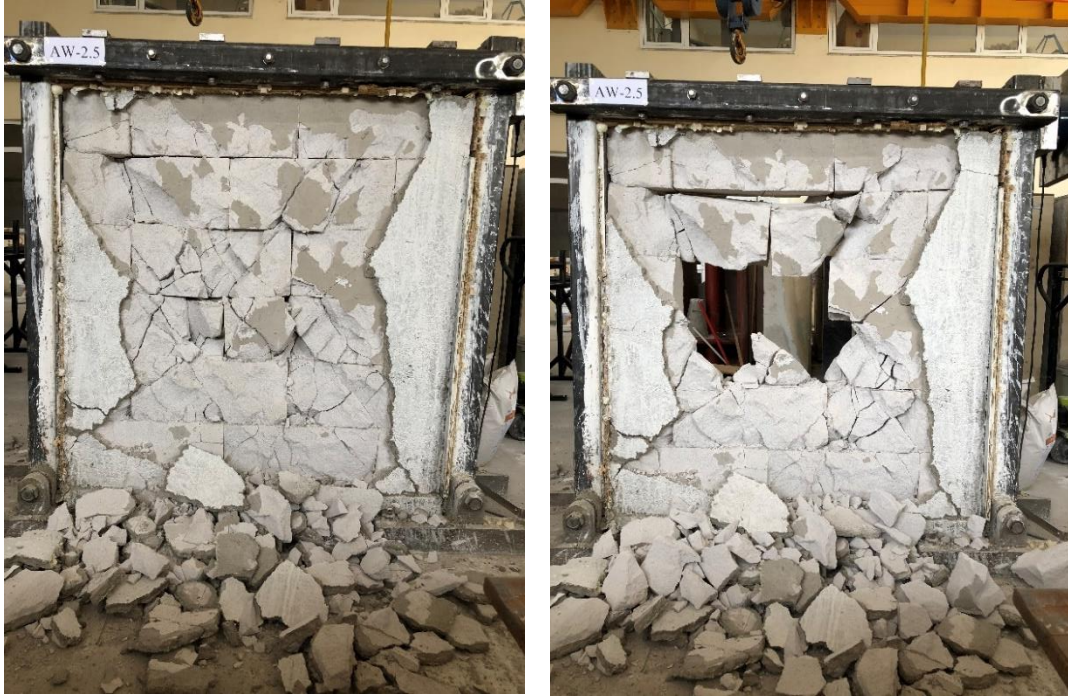
Şekil 4.57. AW-2.5 dolgu duvarının deney sonu görüntüleri
