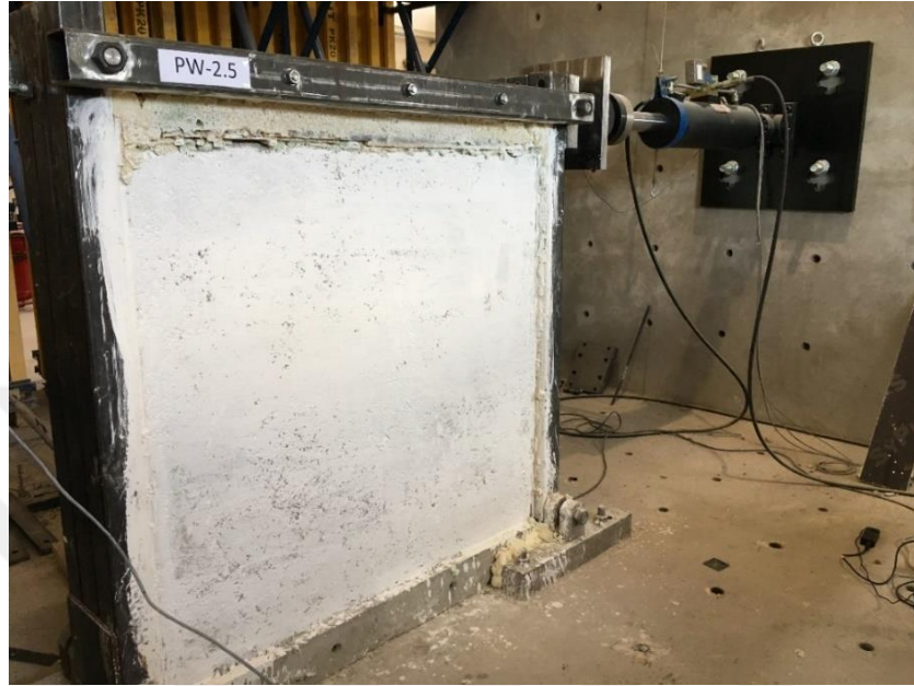
Şekil 4.33. PW-2.5 dolgu duvarının deney başlangıcı görüntüsü
