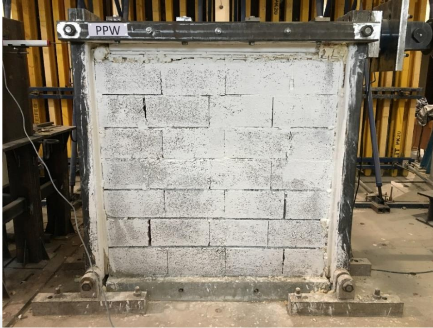
Şekil 3.2. Bims bloklar kullanılarak üretilen dolgu duvar
