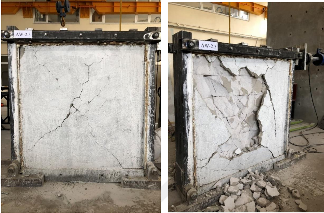
Şekil 4.54. AW-2.5 dolgu duvarının deney sırasında görüntüleri
