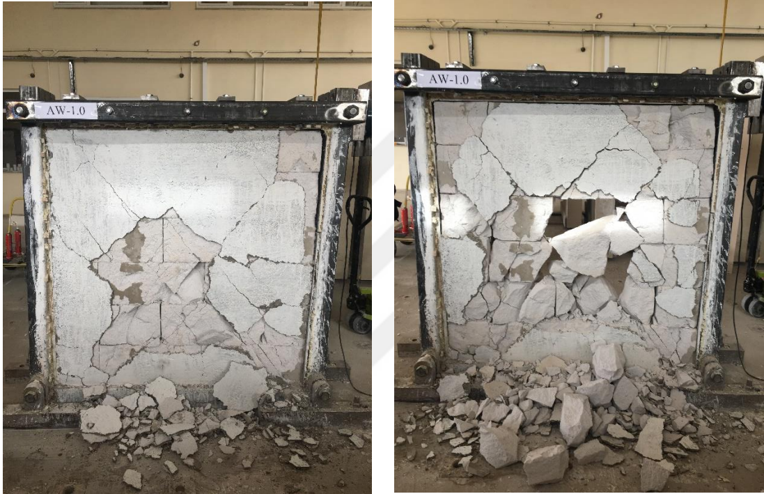
Şekil 4.50. AW-1.0 dolgu duvarının deney sonu görüntüleri
