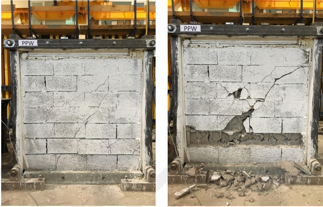
Şekil 4.24. PPW dolgu duvarının deney anı görüntüleri
