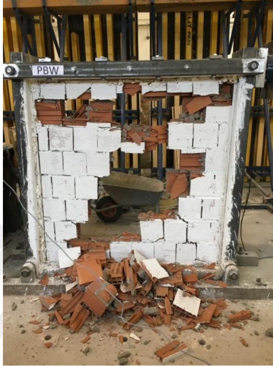
Şekil 4.6. PBW dolgu duvarının deney sonu görüntüsü
