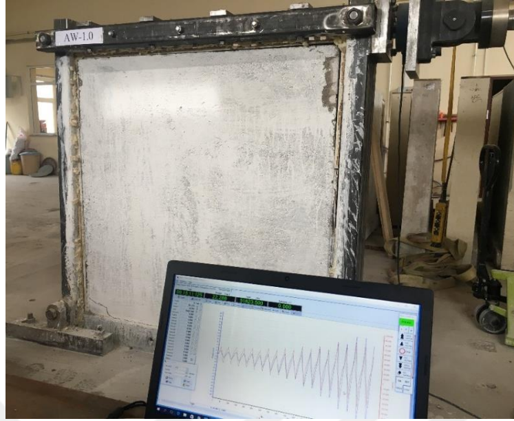
Şekil 4.45. AW-1.0 dolgu duvarının deney başlangıcı görüntüsü
