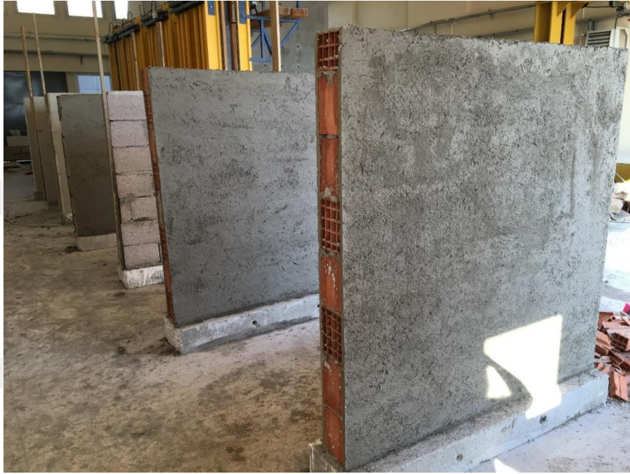
Şekil 3.5. Deneye hazırlanan dolgu duvar numuneleri
