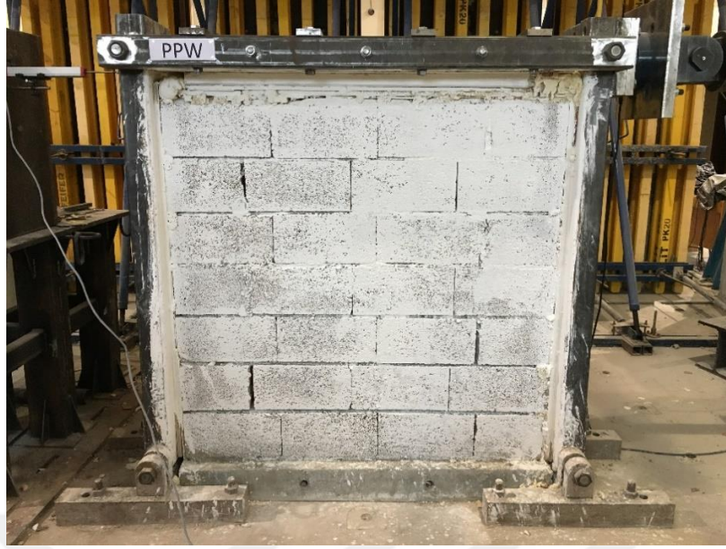
Şekil 4.19. PPW dolgu duvarının deney başlangıcı görüntüsü
