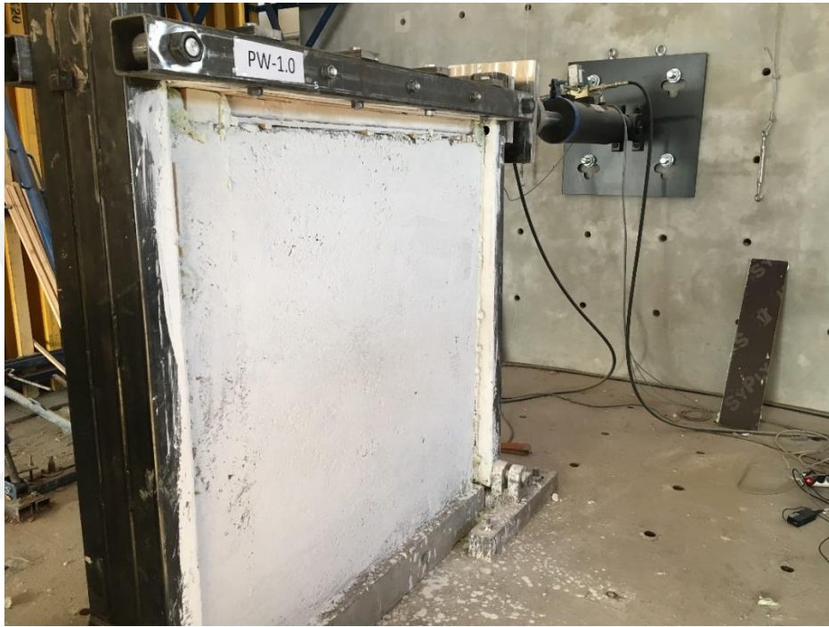
Şekil 4.26. PW-1.0 dolgu duvarının deney başlangıcı görüntüsü
