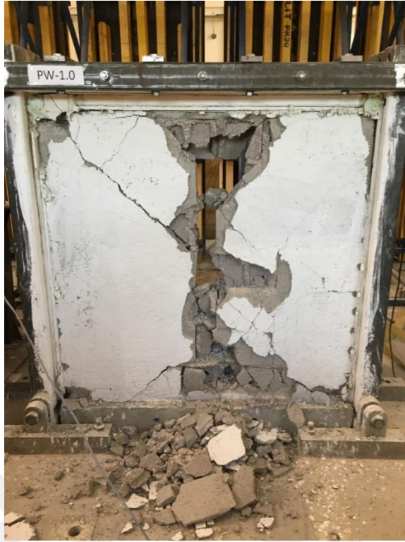
Şekil 4.32. PW-1.0 dolgu duvarının deney sonu görüntüsü
