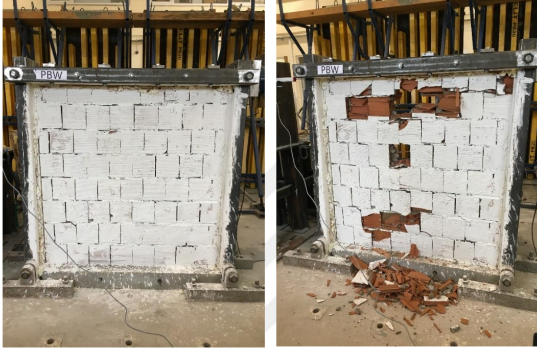
Şekil 4.1. PBW dolgu duvarının deney başlangıcı ve deney anı görüntüleri
