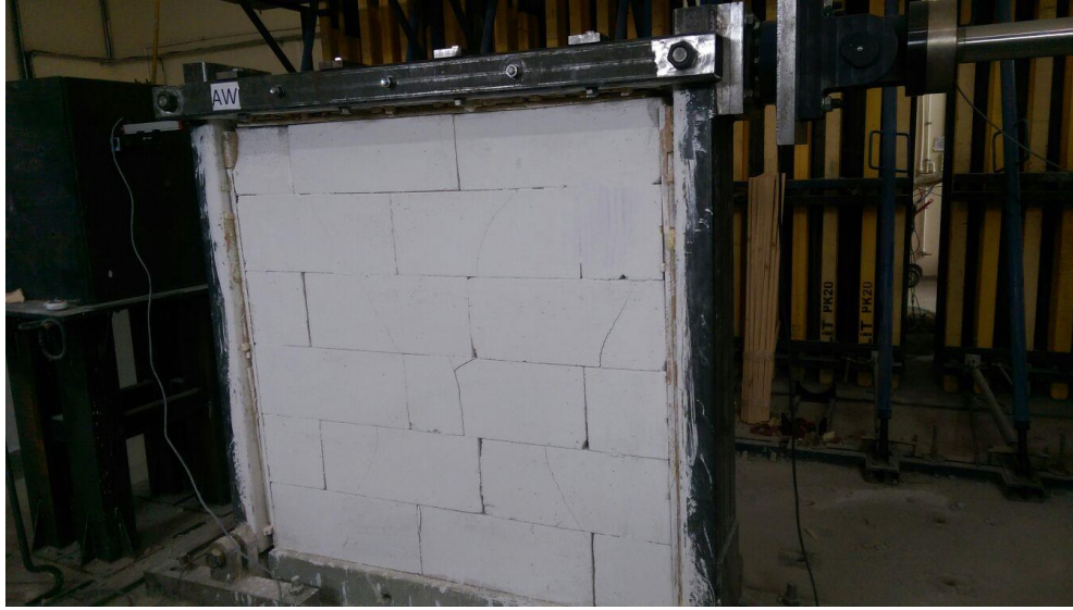
Şekil 3.3. Gazbeton bloklar kullanılarak üretilen dolgu duvar
