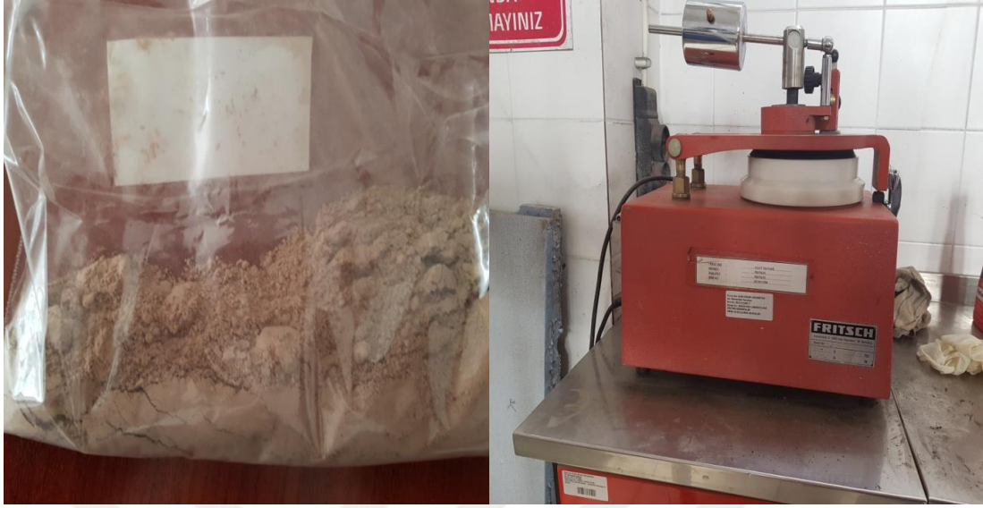
Şekil 3.2. Agat Havanı ve bu cihazda hazırlanan numune örneği.
