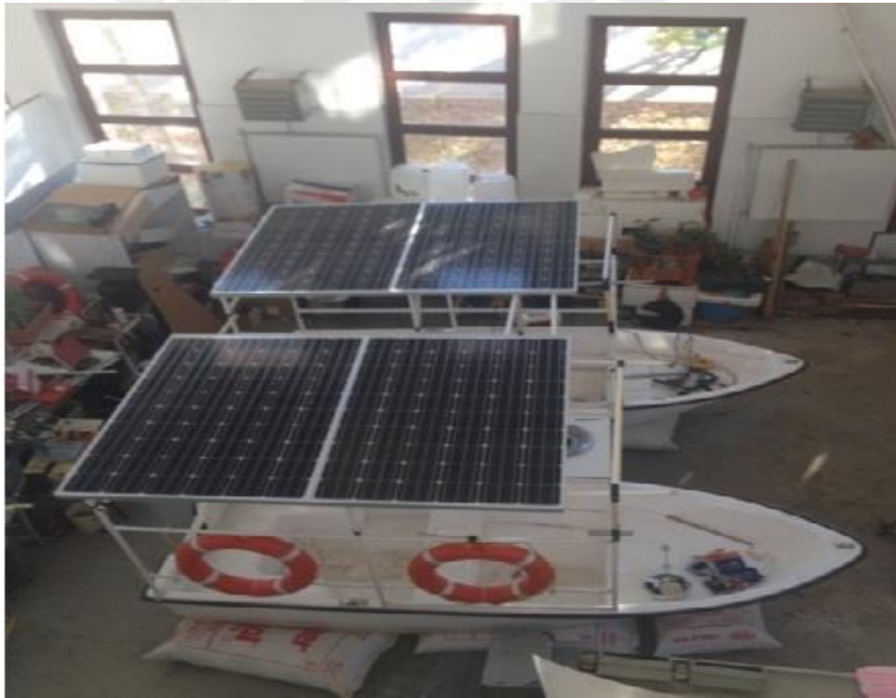
Şekil 2.14. DPÜ Mühendislik laboratuvarlarında üretilen güneş enerjisi ile çalışan tekne SEPV-I (Solar Energy Powered Vessel-I).
