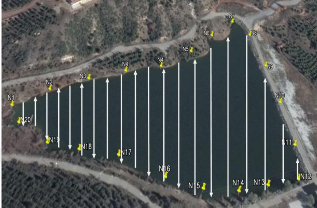
Şekil 3.5. Göletin kuzey-güney doğrultulu yüzey gridleme yöntemi.
