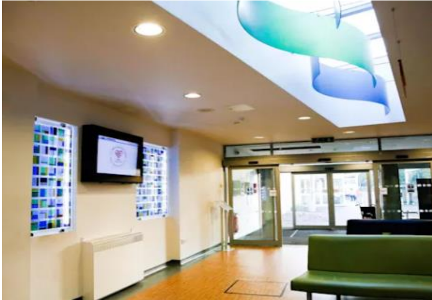
Resim 2.5. Örnek bir acil servis bekleme salonunda doğal ve yapay aydınlatmanın beraber kullanımı
