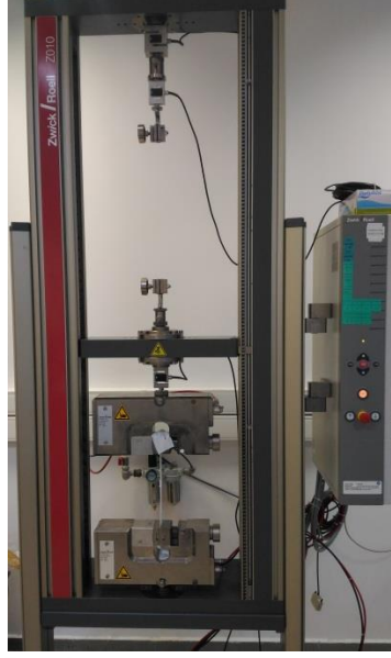
Şekil 4.3. Zwick Roell Z010 iplik ve kumaş mukavemeti cihazı.
