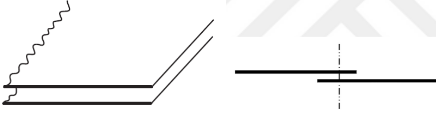
Şekil 3.20. Birleştirme dikim tipi (McLoughlin and Mitchell, 2015).
