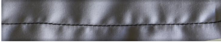
Şekil 3.27. Kumaş katlarının eşit beslenmemesi sonucu oluşan dikiş büzgüleri (Carvalho et al., 2015).
