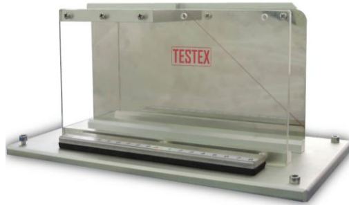
Şekil 4.7. Shirley sertlik ölçeri ( http://www.testertextile.com ).
