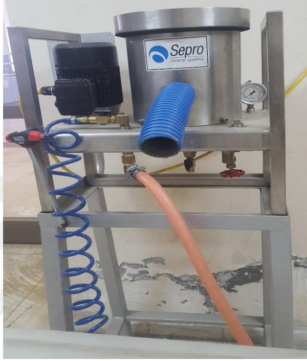
Şekil 4.3 L40 laboratuvar tipi Falcon konsantratör
