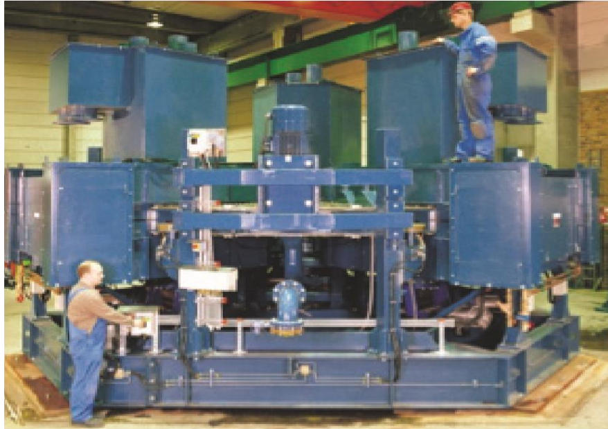
Şekil 2.12 Metso Carousel yüksek alan şiddetli manyetik ayırıcı [38]
