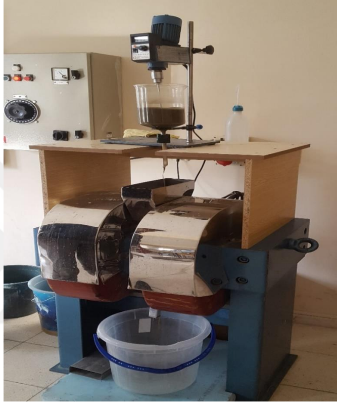
Şekil 4.2 Boxmag Rapid marka LHWL model yağ manyetik ayırıcı
