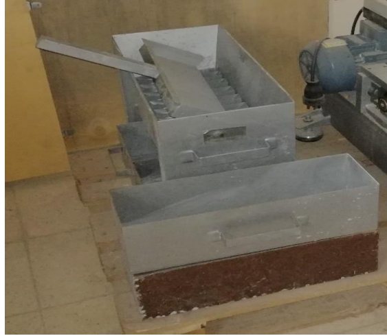
Şekil 4.1 On iki bölmeli numune bölücü
