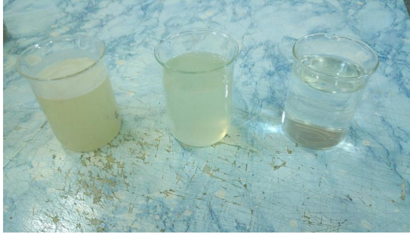
Şekil 4. 1 MBR'de kullanılan ilk besleme atıksuyu (sol), ikinci besleme atıksuyu (orta) ve elde edilen süzüntünün (sağ) fiziksel olarak karşılaştırılması
