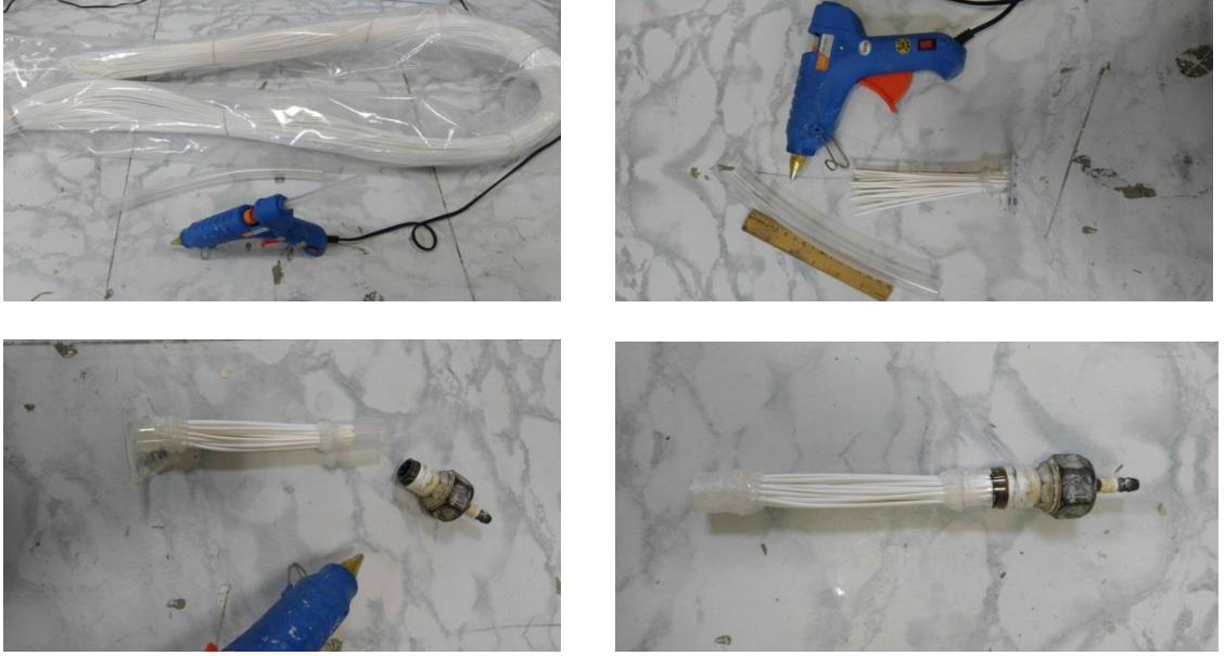
Şekil 3. 3 Hollow fiber membran modülü yapım aşaması
