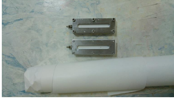
Şekil 3. 8 Flat sheet membran ve deney için hazırlanmış membran modülü
