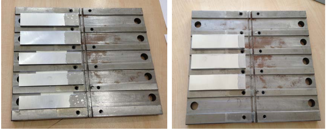
Şekil 3.9. Deney numunelerine yapıştırıcı uygulanması
