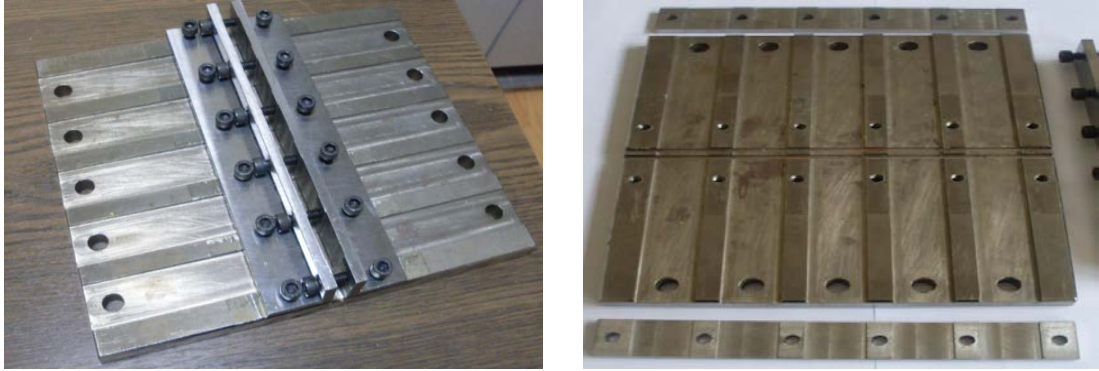
Şekil 3.8. Numunelerin üretilmesinde kullanılan kalıp
