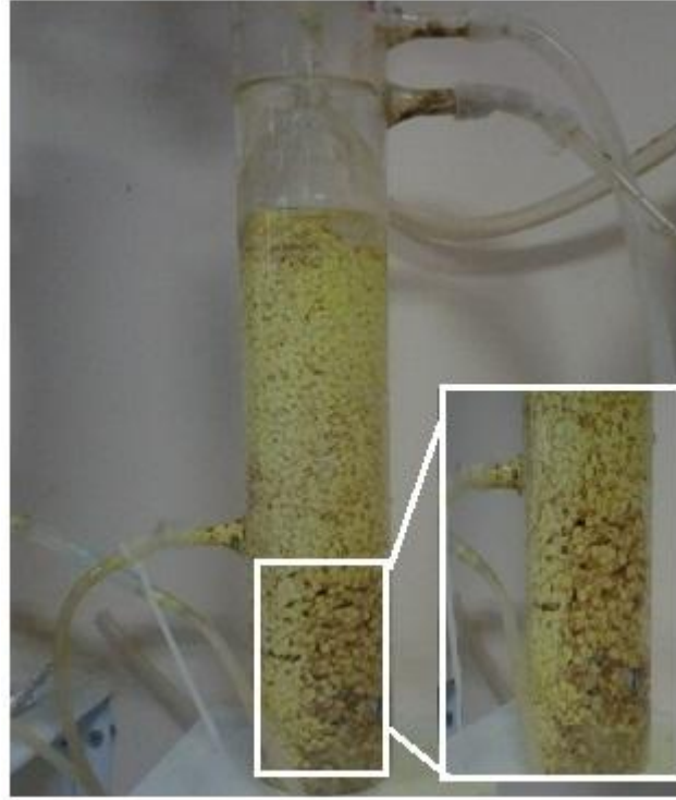
Şekil 3.4. Elementel kükürt (1,5-4,0 mm) ile doldurulmuş akışkan yataklı kolon (AYR) reaktör fotoğrafları
