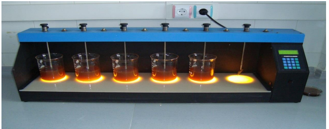
Şekil 3.2. Fenton denemelerinin gerçekleştirildiği deney düzeneği
