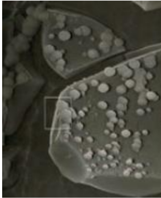
Şekil 2. Vücut sıvısıyla etkileşime giren biyoaktif cam partikülü üzerinde hidroksikarbonat apatit (1 gün sonra)
