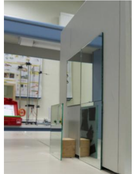
Şekil 3.b. Dört parçaya bölünmüş aynanın bir parçasının bir miktar öne getirildiğini gösteren fotoğraf
