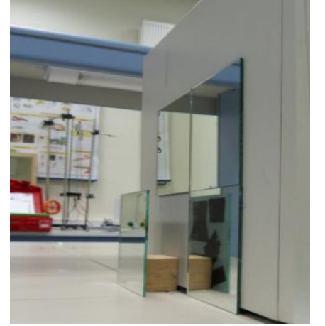
Şekil 3.b. Dört parçaya bölünmüş aynanın bir parçasının bir miktar öne getirildiğini gösteren fotoğraf
