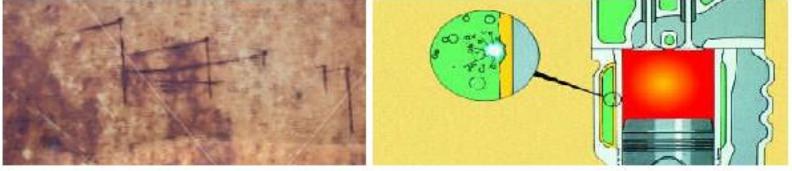
Şekil 2.12. Oyuklanma korozyonu ve oluşumu (Anonim 2009)
