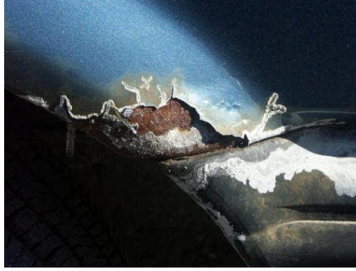
Şekil 2.14. Kaplama hatası nedeniyle kaplama altında oluşmuş korozyon (Anonim 2009)
