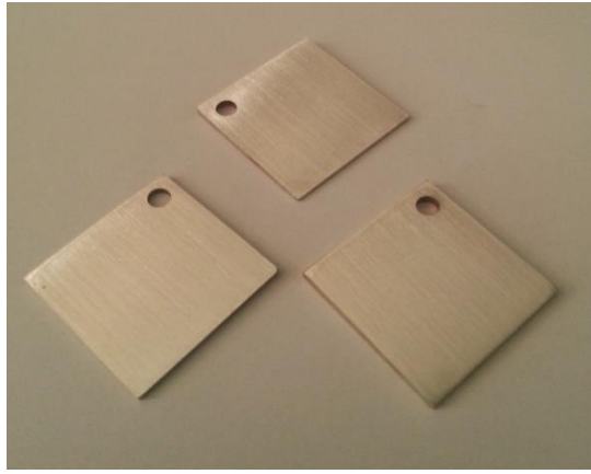
Şekil 2.1. Kare kesitli magnezyum örnekleri
