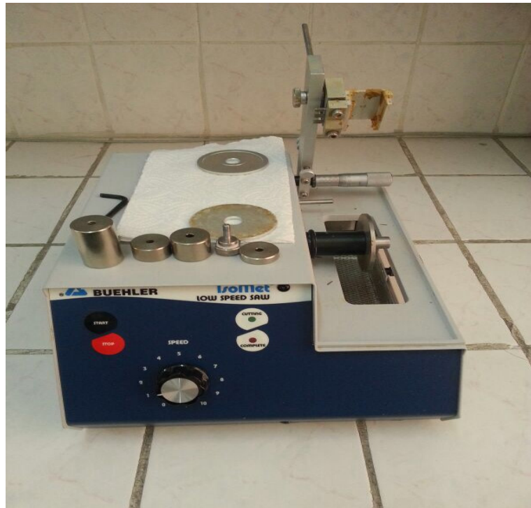
Şekil 3-12: Hassas kesme cihazının parçaları ile görünümü
