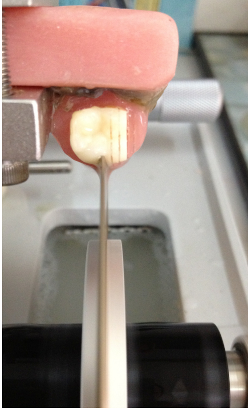
Şekil 3-28: Elmas bıçak yardımıyla örneklerin kesilmesi
