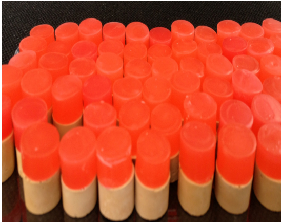
Şekil 3-21: Örneklerin pembe mum yardımıyla muflalama işlemine hazır hale getirilmesi
