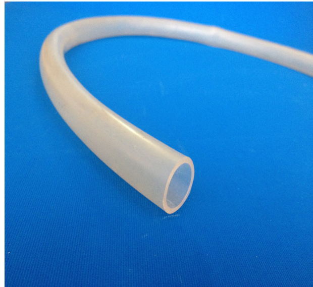
Şekil 3-19: Örneklerin oluşturulması için hazırlanan pvc halka ve bu halkaların kesildiği pvc borunun görünümü
