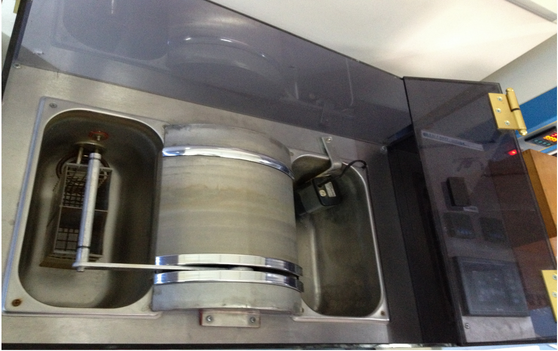
Şekil 3-31: Örneklerin yerleştirildiği termosiklus cihazı
