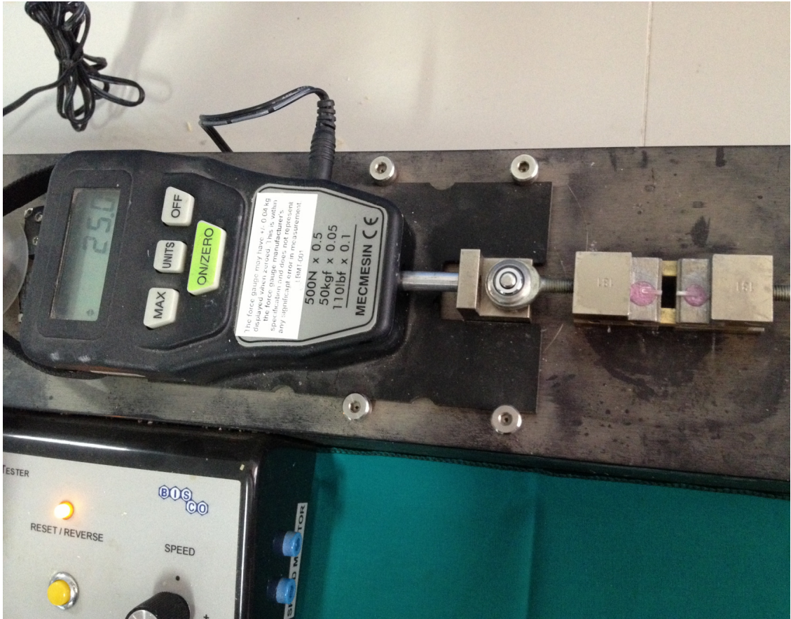
Şekil 3-34: Mikro gerilim bağlanma dayanımı ölçümü
