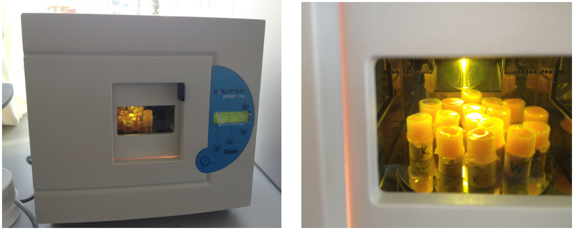
Şekil 3-24: Görünür ışık ile polimerize olan örneklerin görünümü
