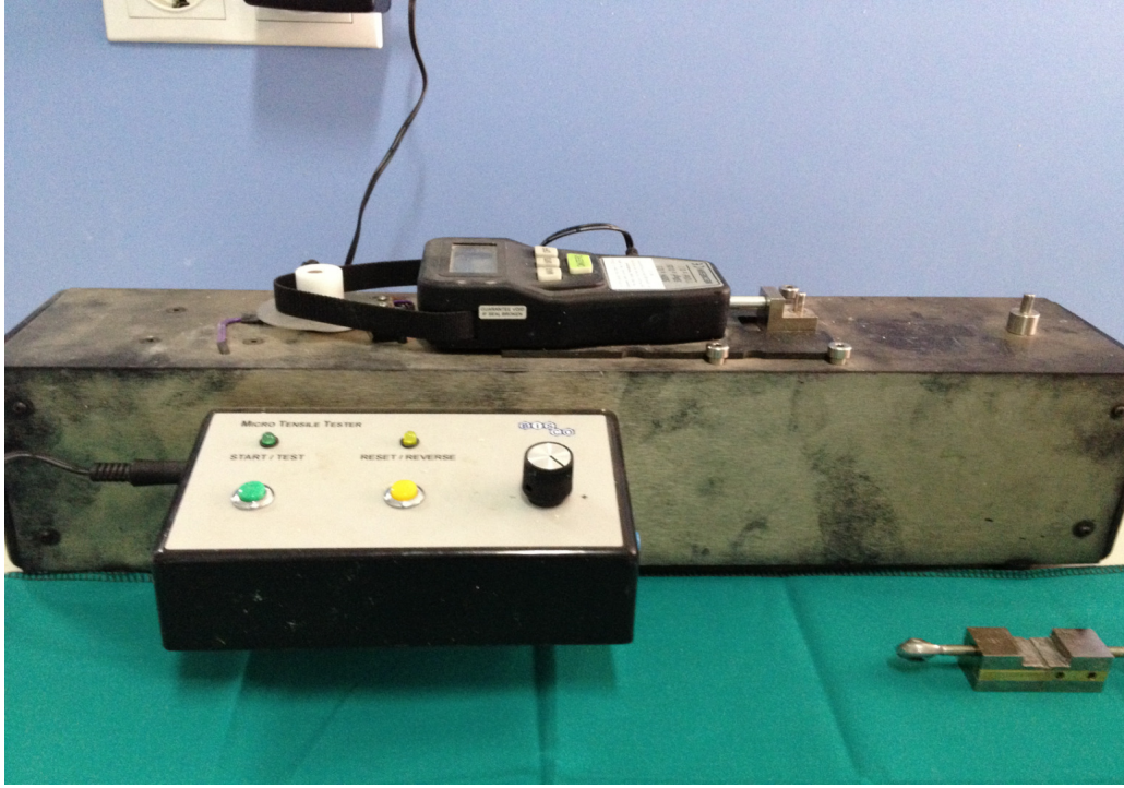
Şekil 3-15: Mikro gerilim test cihazının yandan görünümü
