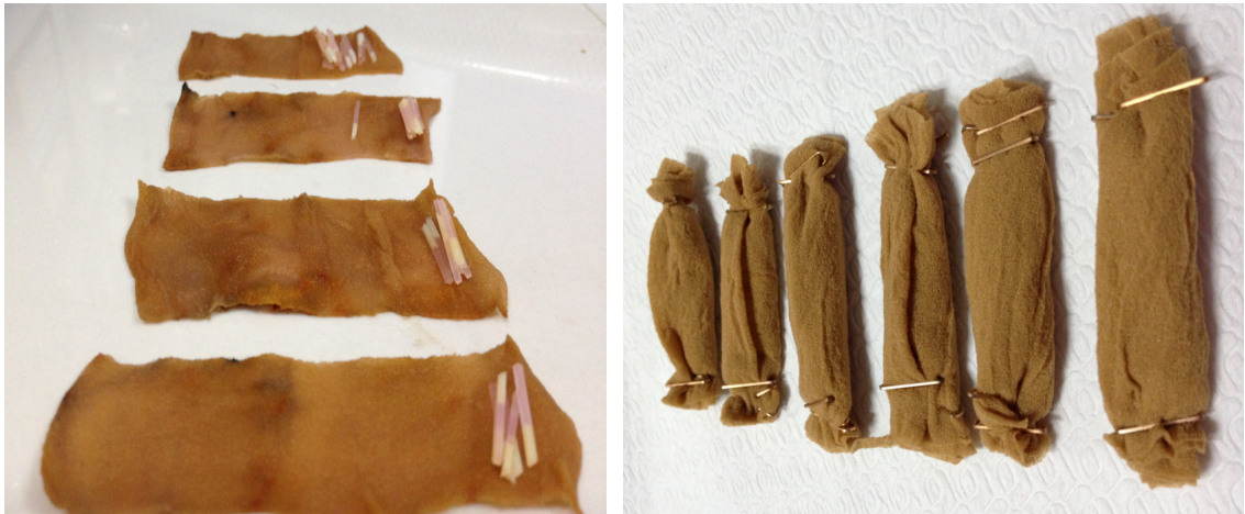
Şekil 3-30: Termosiklusa yerleştirilmek üzere hazırlanan örnek görünümü
