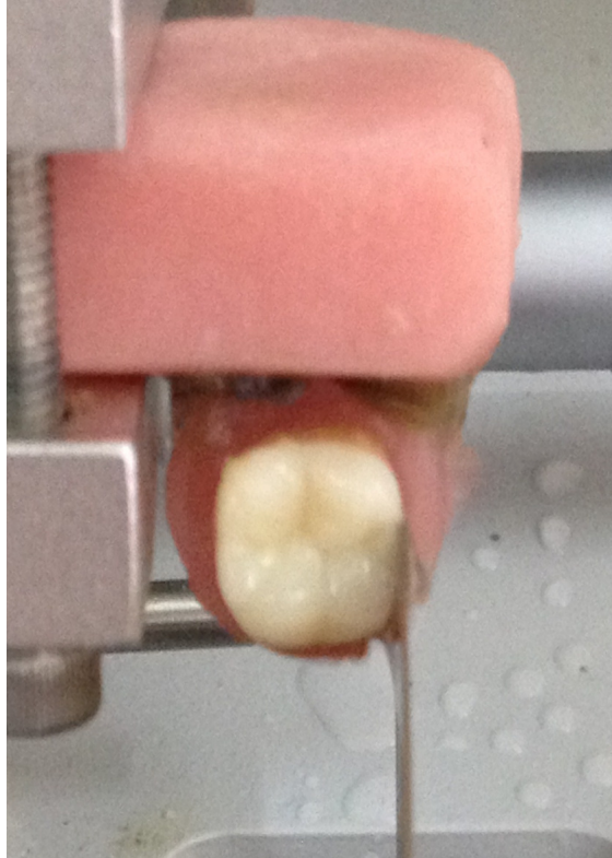
Şekil 3-27: Sirkolan mum yardımıyla hassas kesme cihazına yerleştirilmiş örnek görünümü
