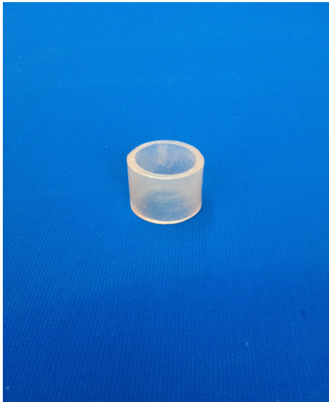
Şekil 3-19: Örneklerin oluşturulması için hazırlanan pvc halka ve bu halkaların kesildiği pvc borunun görünümü
