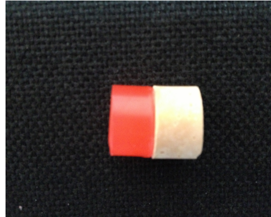
Şekil 3-21: Örneklerin pembe mum yardımıyla muflalama işlemine hazır hale getirilmesi
