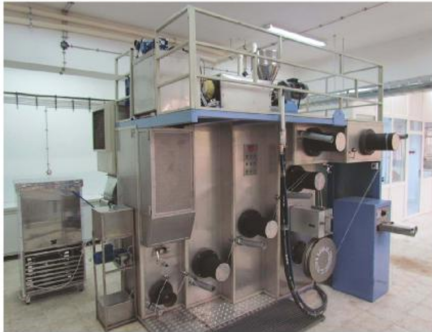
Şekil 3.9. Laboratuvar tipi filament iplik üretim makinesinin teknik çizimi ve genel görünümü
