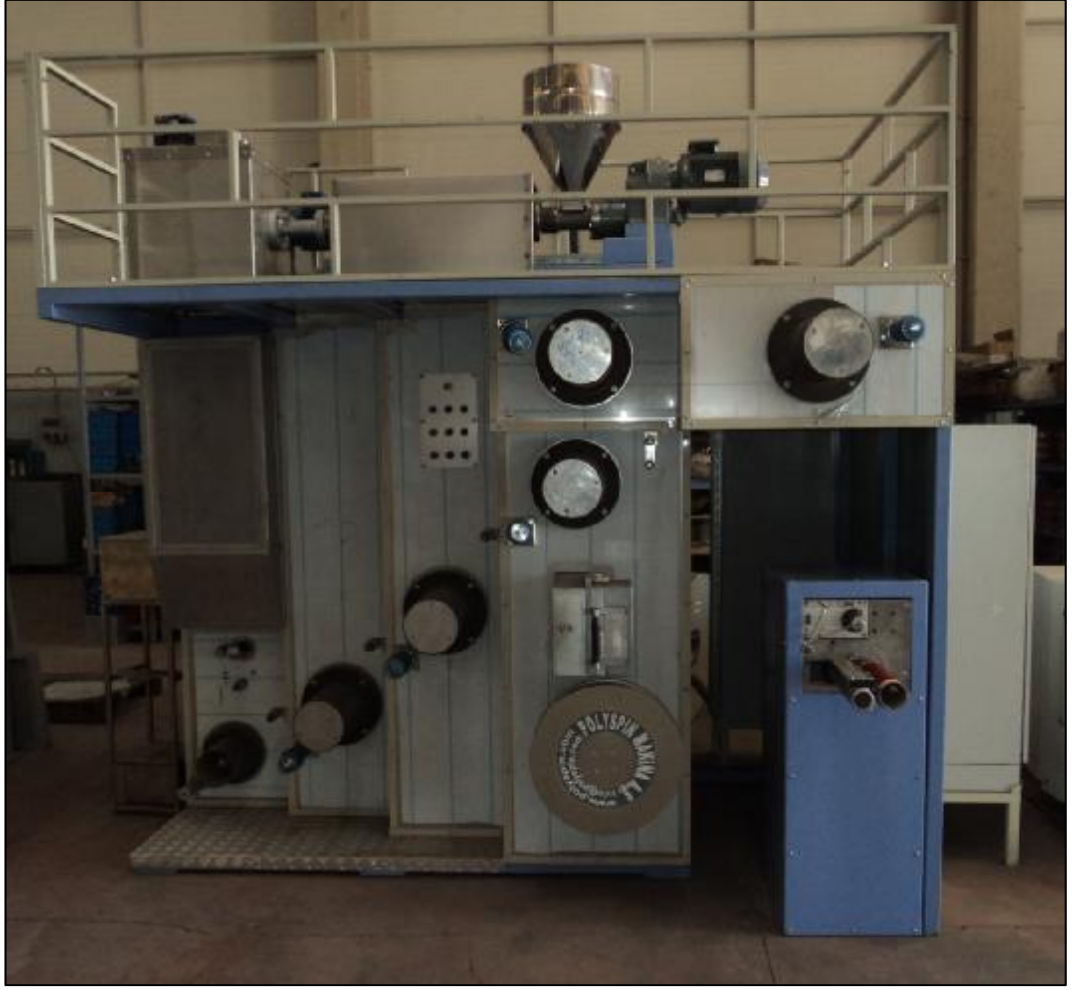
Şekil 3.6. Laboratuvar tipi filament iplik üretim makinesinin besleme hunisi, ekstrüder, yağ tankı ve sarım ünitesi montajlarının tamamlanması
