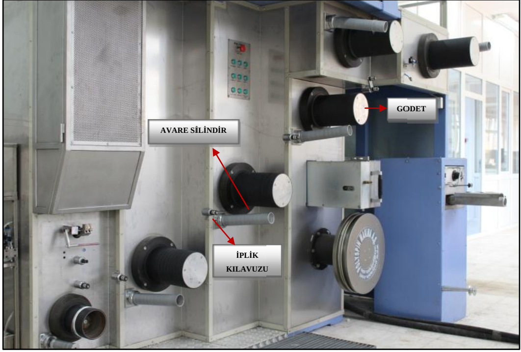
Şekil 4.21. Çekim ünitesi elemanları olan godetler, avare silindirler ve iplik kılavuzları
