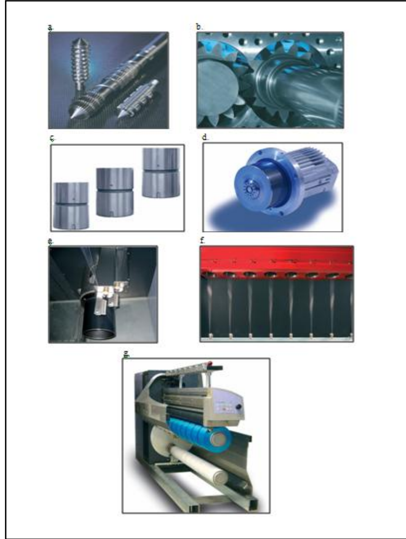
Şekil 3.1. Filament iplik üretim makinesinin bazı elemanları (MEGEP, 2010) (a. Ekstrüder Vidası, b. Metraj Pompası, c. Düze Paketi, d. ve e. Godet, f. Yağlayıcı Ünite, g. Sarım Ünitesi)
