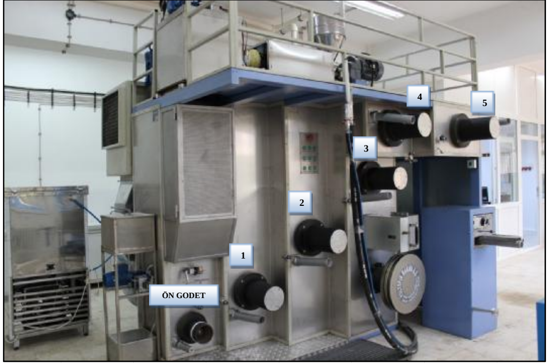
Şekil 4.18. Filament iplik üretim makinesi çekim ünitesi ve godetleri
