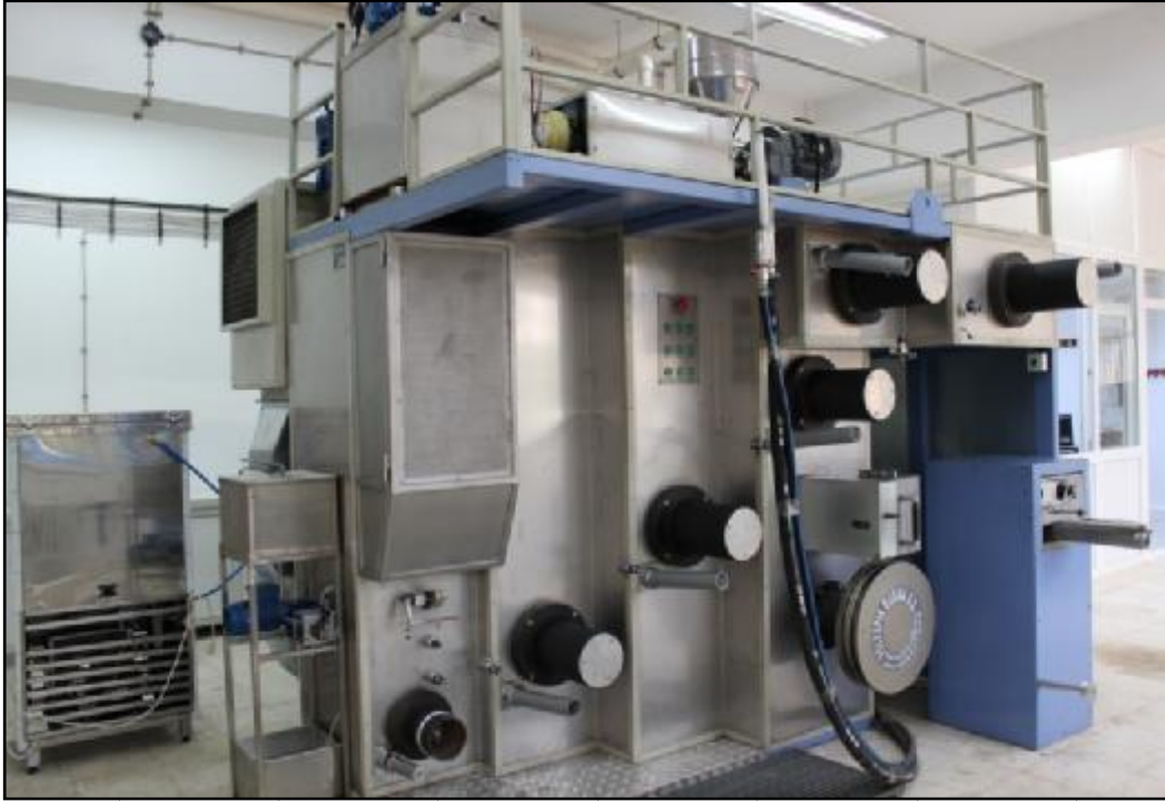
Şekil 3.5. İmalatı gerçekleştirilen laboratuvar tipi filament iplik üretim makinesi
