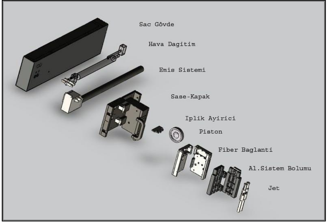
Şekil 3.11. Sıcak hava jetli ve tamburlu tekstüre ünitesi elemanları
