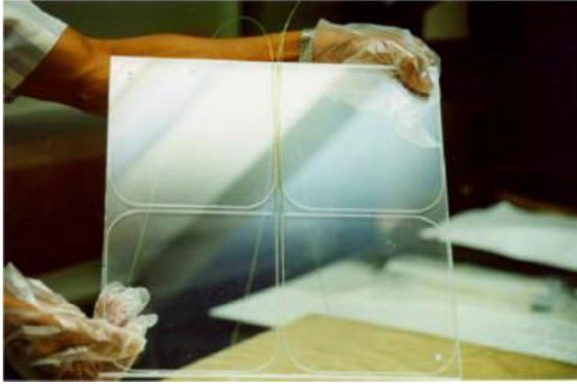
Şekil 3.9. HO sintilatör döşemesi (CMS Collaboration, 2008, JINST 3 S08004).
