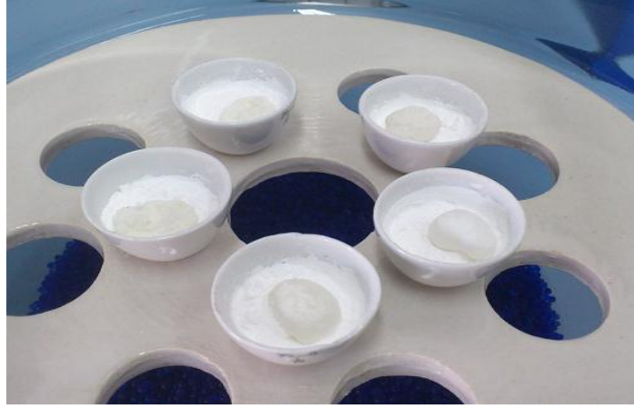
Şekil 4.2 Hammadde karışımlarının peletleri
