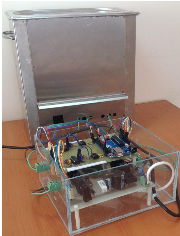
Şekil 4.2 Tasarlanan ultrasonik temizleme sistemi.
