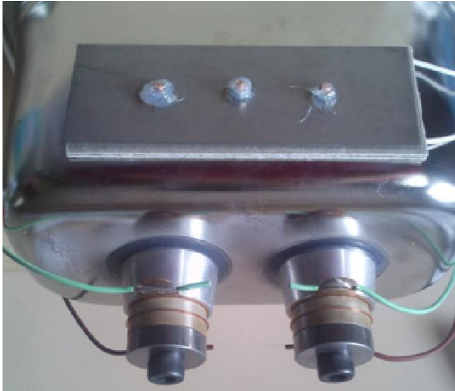
Şekil 2.9 Tez çalışmasında kullanılan kazana alttan yapıştırılmış dönüştürücüler.
