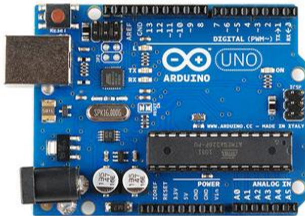
Şekil 4.3 ATmega 528 tabanlı ARDUINO-UNO kontrol kartı.
