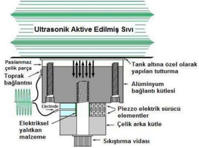
Şekil 2.8 Piezo seramik dönüştürücünün iç yapısı.
