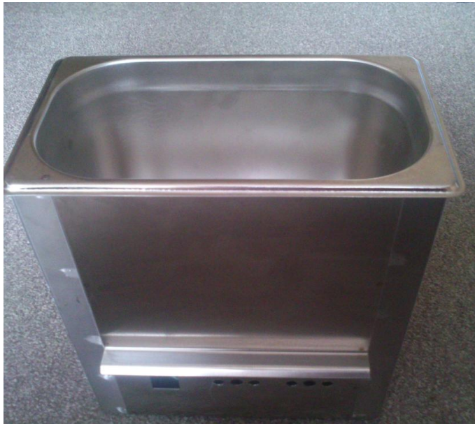
Şekil 2.10 Tez çalışmasında kullanılan 4lt kapasiteli temizleme tankı.
