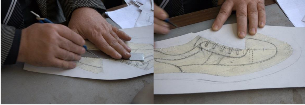
Şekil 141 : Burun ve aynanın kesilmesi
