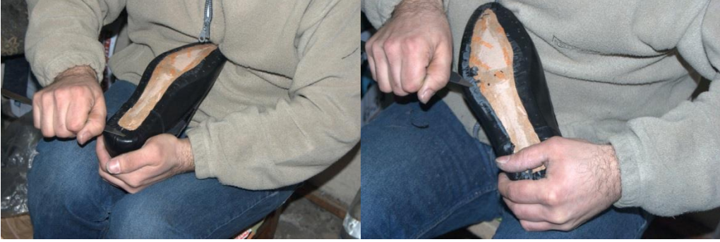
Şekil 219 : Taban fazla derilerin tıraşlanması
