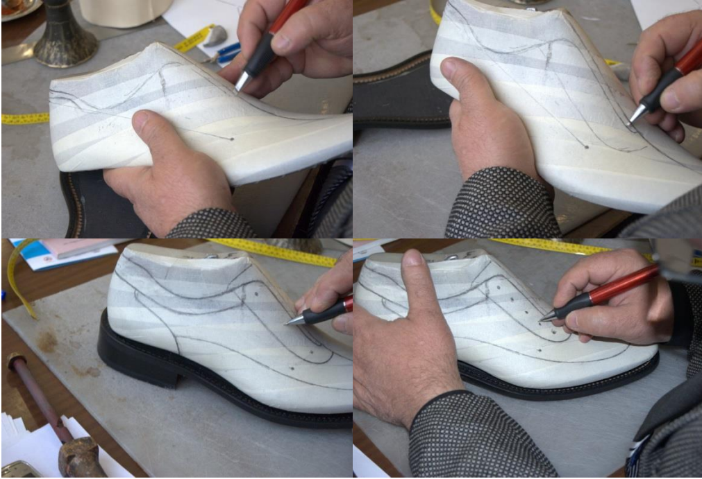
Şekil 130 : Bağcık ve ayna çizgilerinin çizilmesi
