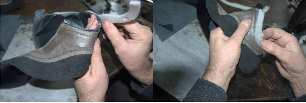
Şekil 187 : Pedleri yastık bölümüne yerleştirme
