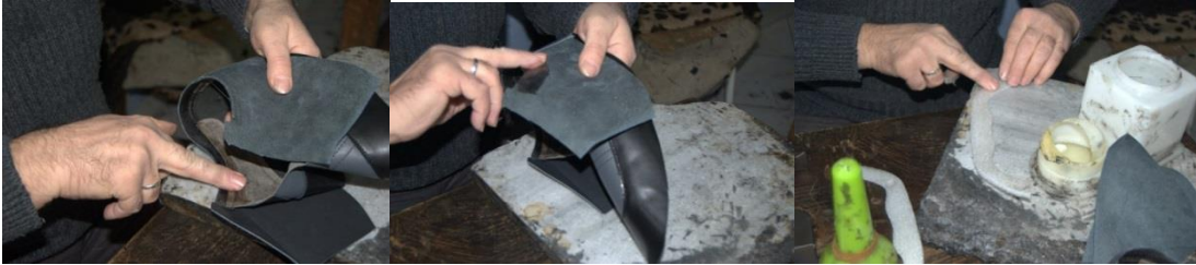
Şekil 174 : Dikilen parçalar ve pedin ilaçlanması
