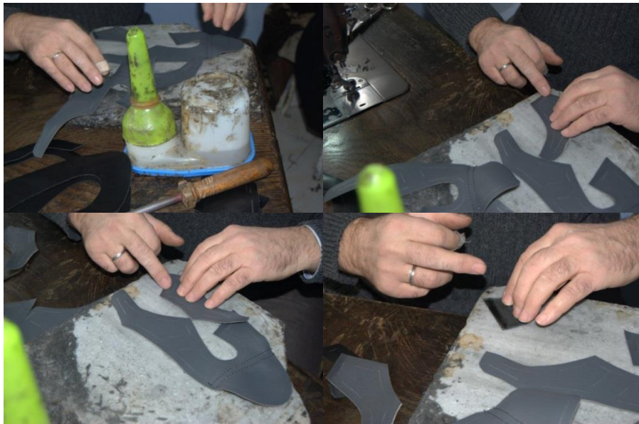
Şekil 168 : Ayna bölümünün ilaçlanması
