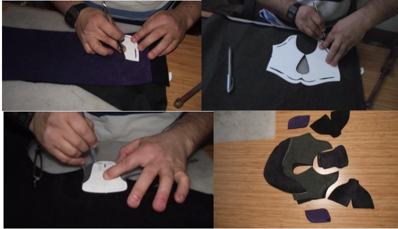
Şekil 92 : Yüzlük malzemelerin kesimi
