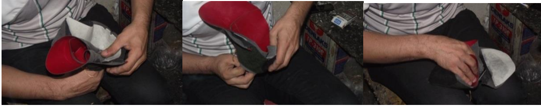
Şekil 105 : Fort- bombe telalarının yerleştirilmesi
