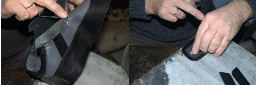
Şekil 175 : Bağcık yerlerinin ilaçlanması
