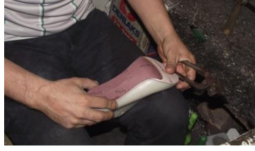
Şekil 104 : Alt tabanın yapıştırılması
