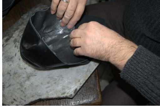
Şekil 190 : Ayna astarını yapıştırma
