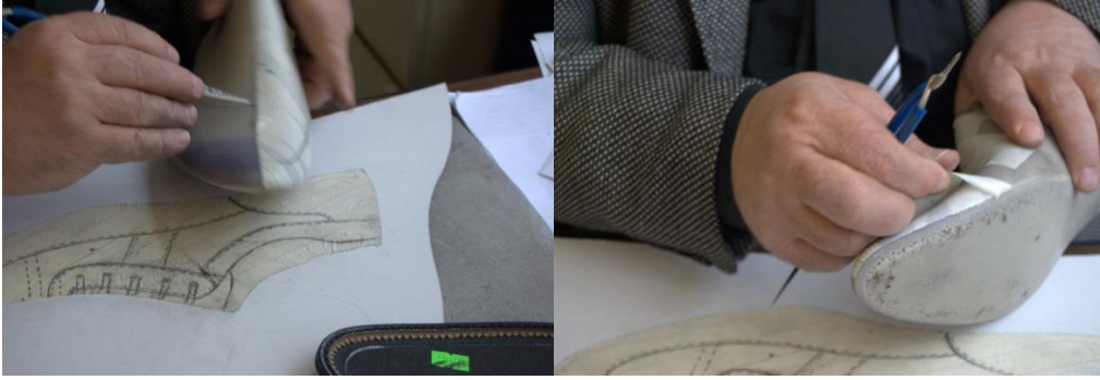
Şekil 138 : Kalıptan ayna kısmının çıkartılması
