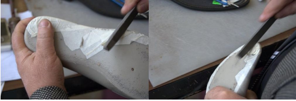
Şekil 134 : Eğe ile bantların temizlenmesi
