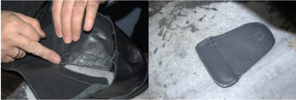
Şekil 177 : Dilin birleşim yerlerinin ilaçlanması
