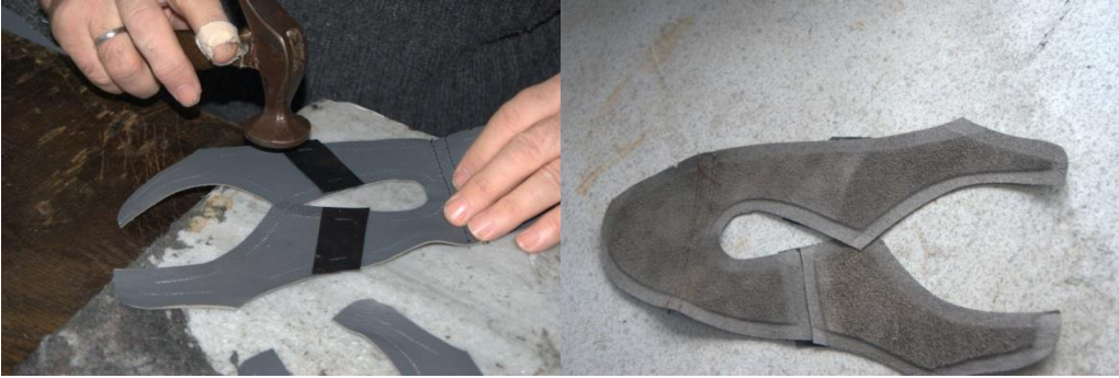
Şekil 179 : Çekiçle yapıştırmanın sağlamlaştırılması
