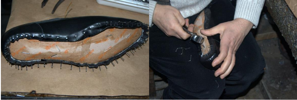
Şekil 217 : Taban çivilerinin temizlenmesi
