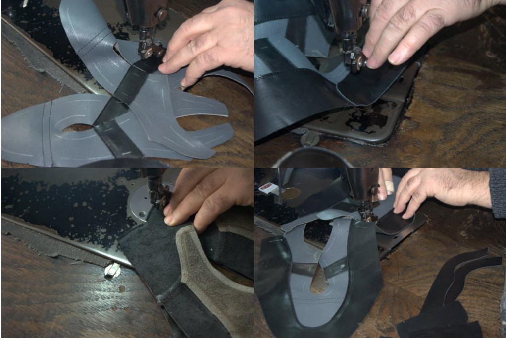
Şekil 193 : Yapıştırılan parçaların dışlarının yapımı
