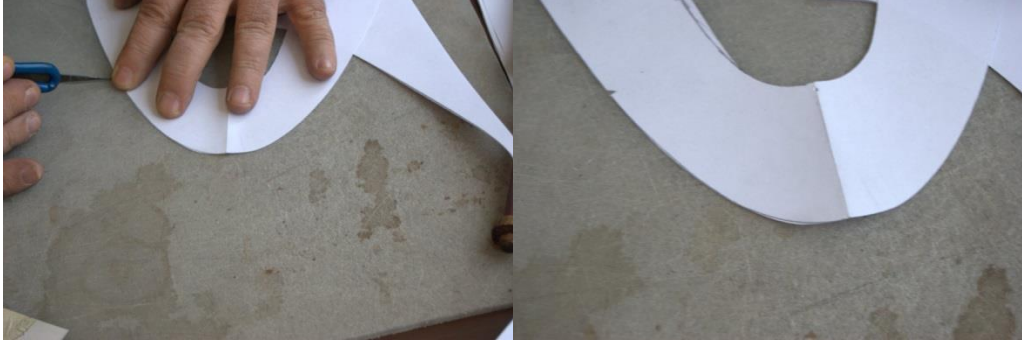
Şekil 148 : Sađ - sol entiklerinin atılması
