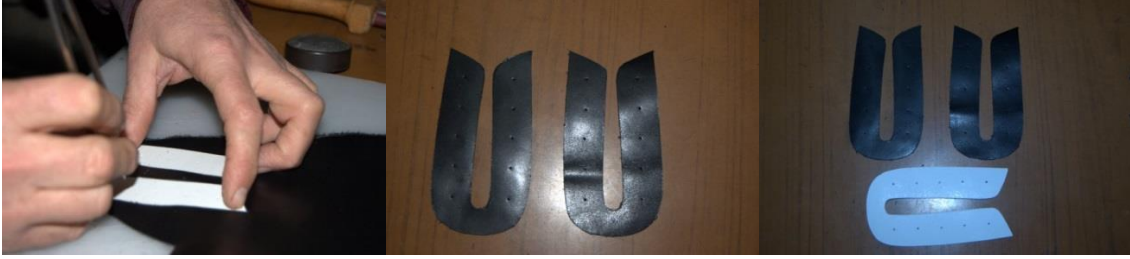
Şekil 158 : Bağcık bölümünün kesilmesi
