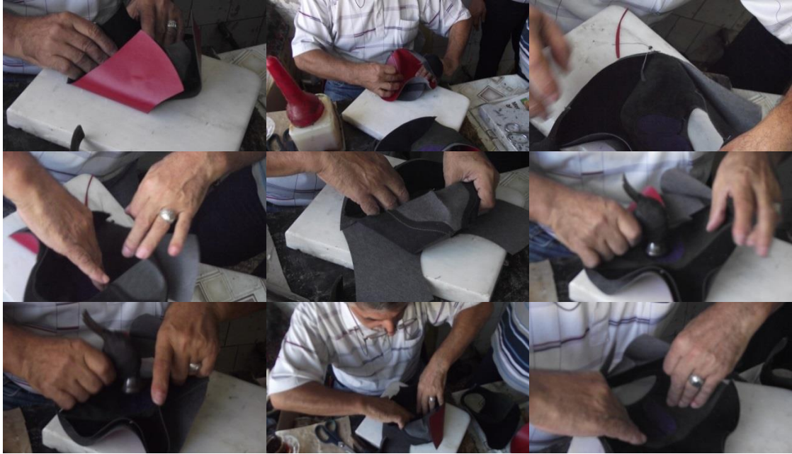
Şekil 101 : Astarın arka çatım işleminin yapılması
