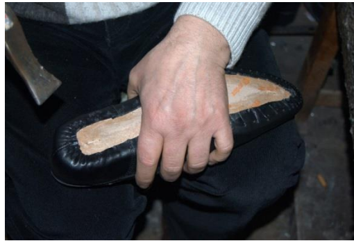
Şekil 218 : Tabana pistirizma yapımı
