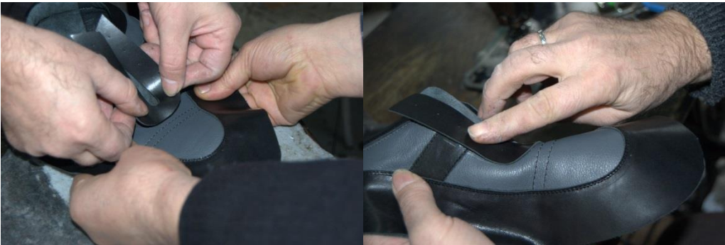
Şekil 189 : Bağcık parçalarının yerleştirilmesi
