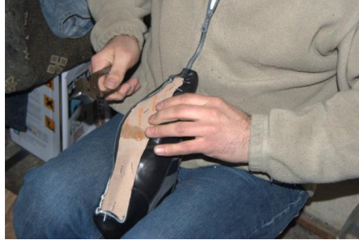
Şekil 210 : Yardımcı çivilerin çıkartılması
