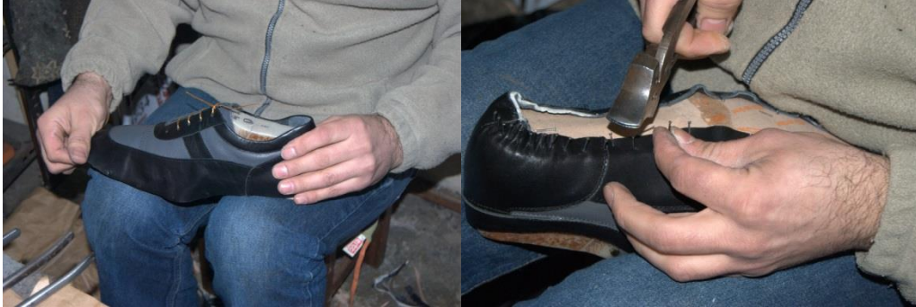
Şekil 208 : Ayakkabıyı kalıba çekme
