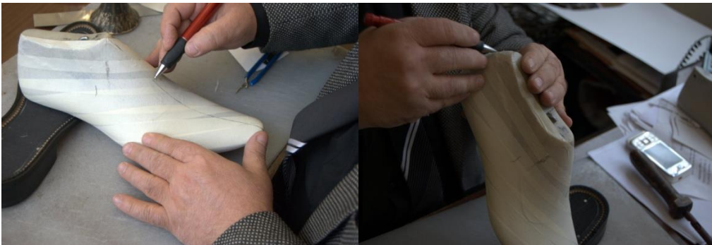
řekil 125 : n ve arka ortasının belirleme
