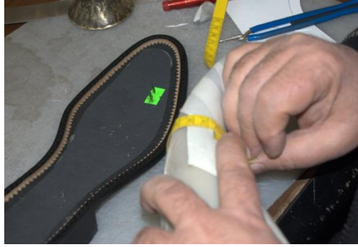
Şekil 127 : Tarak ölçüsü alma
