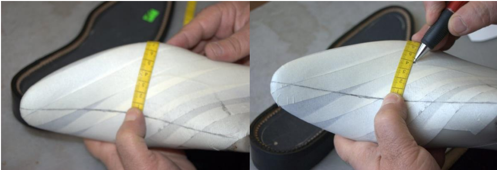
Şekil 128 : Tarak çizgisinde orta noktayı bulma
