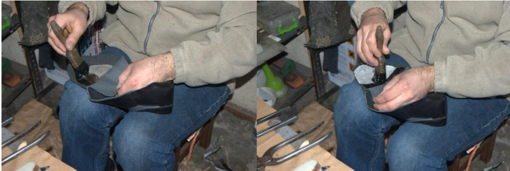
Şekil 206 : Bombe telasını yapıştırma
