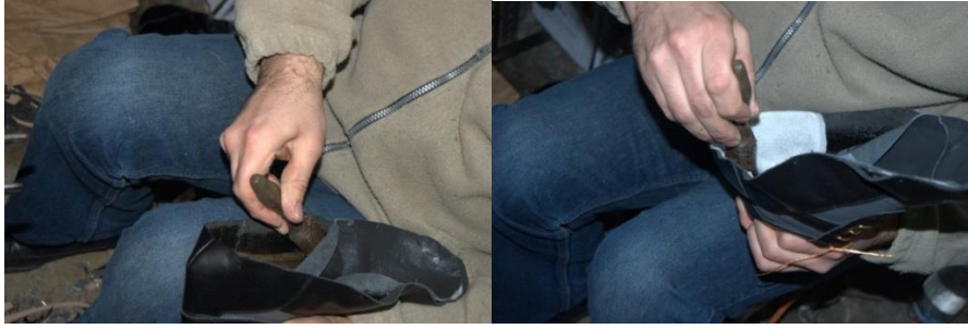
Şekil 207 : Fort telasını yapıştırma
