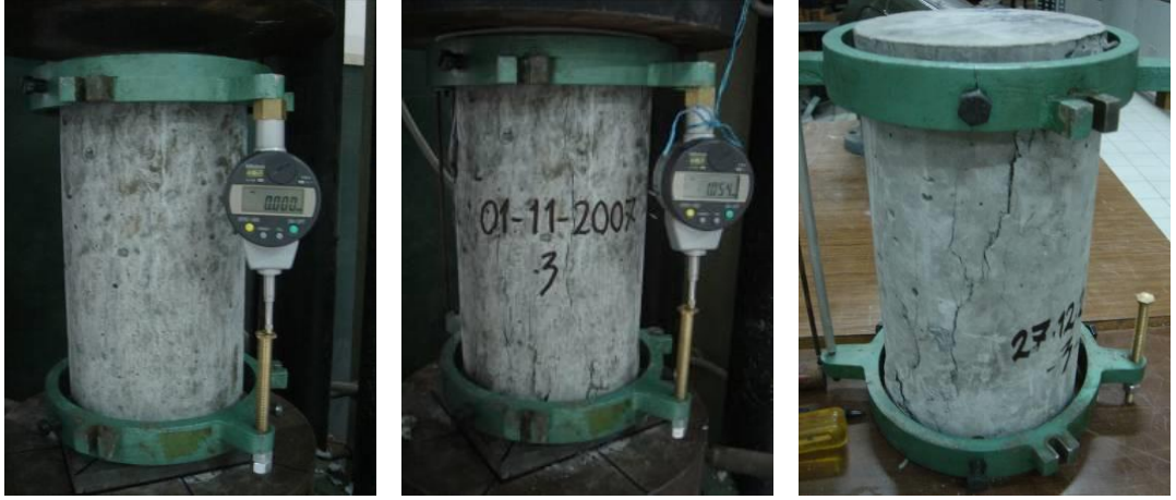
Şekil 3.18 : Elastisite modülü tayini için deformasyon ölçüm deneyi.
