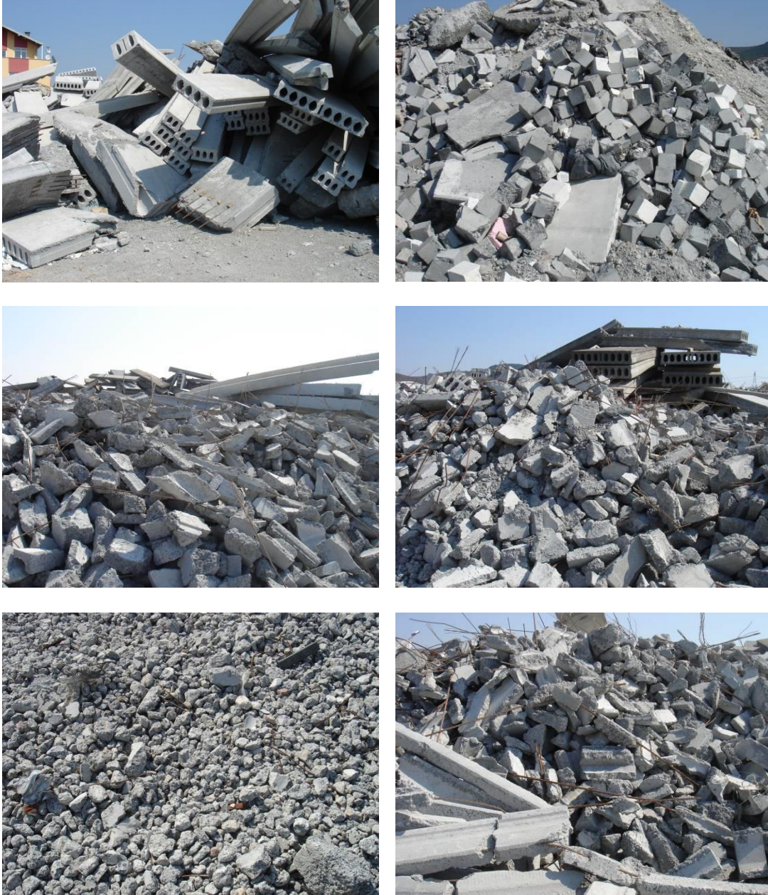
Şekil 3.2 : Prefabrikasyon firması üretim tesisinin stok sahasındaki beton prefabrikasyon atıkları.
