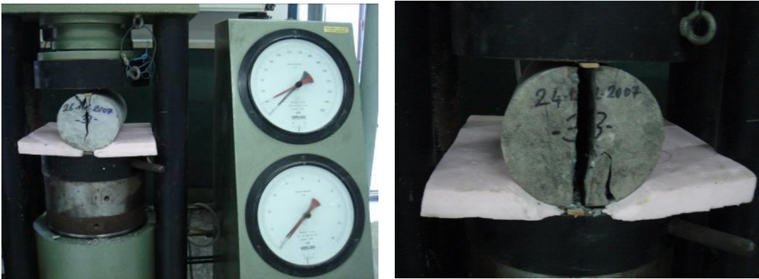
Şekil 3.17 : Yarmada çekme dayanımı tayini deneyi.
