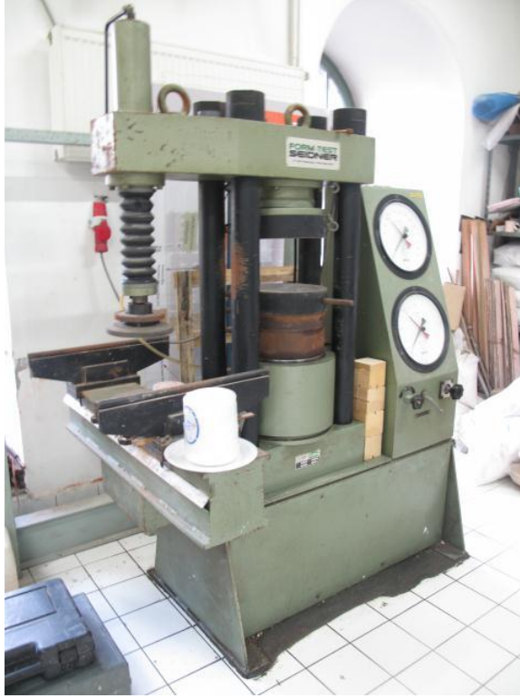
Şekil 3.21 : Basınç ve yarmada çekme deneylerinin yapıldığı Form-Test Seidner marka 300 ton basınç, 10 ton çekme kapasiteli universal deney aleti.
