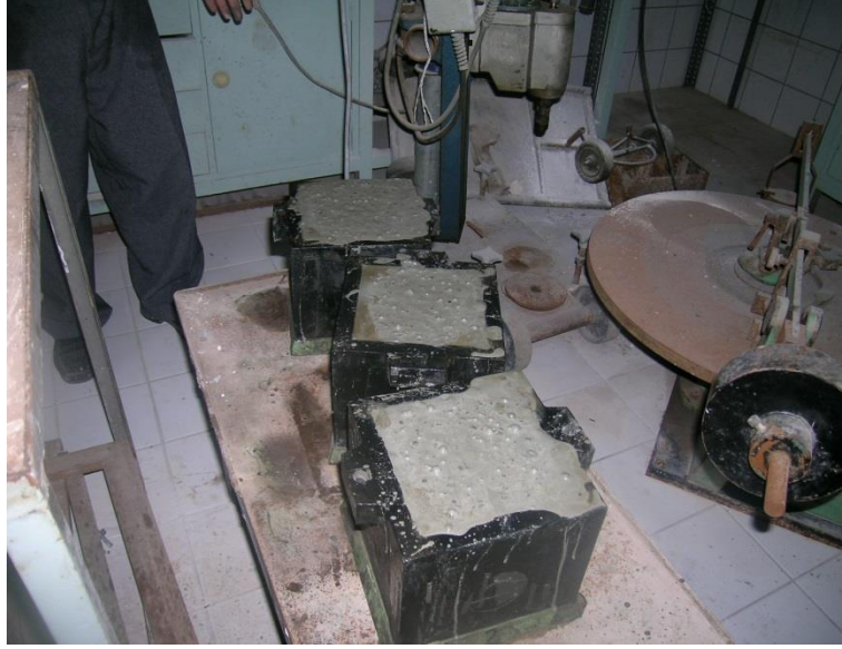
Şekil 3.13 : Betonun sarsma tablasında mekanik titreşim yoluyla kalıplara yerleştirilmesi.
