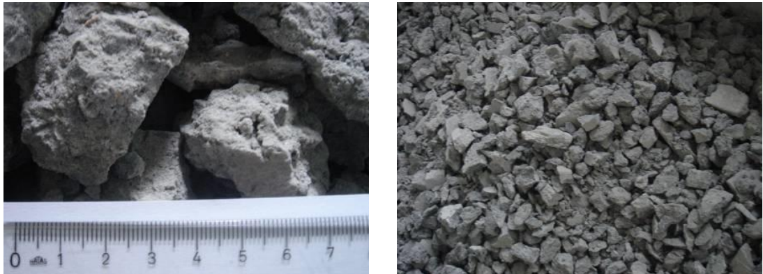
Şekil 3.4 : Birincil kırıcıdan geçirilen beton parçaları.
