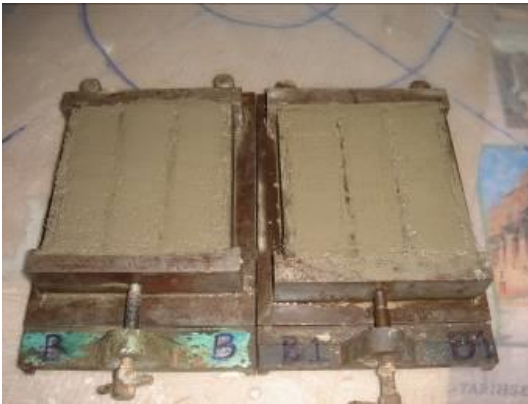
Şekil 3.9 : Çimentonun karıştırılması, kalıba yerleştirilmesi ve suda kürlenmesi.
