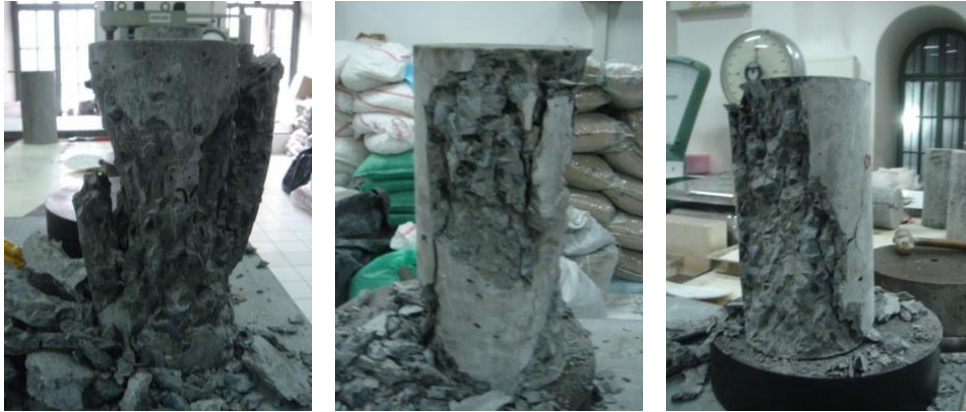
Şekil 3.24 : Kırılmış silindir numunelerden örnekler.
