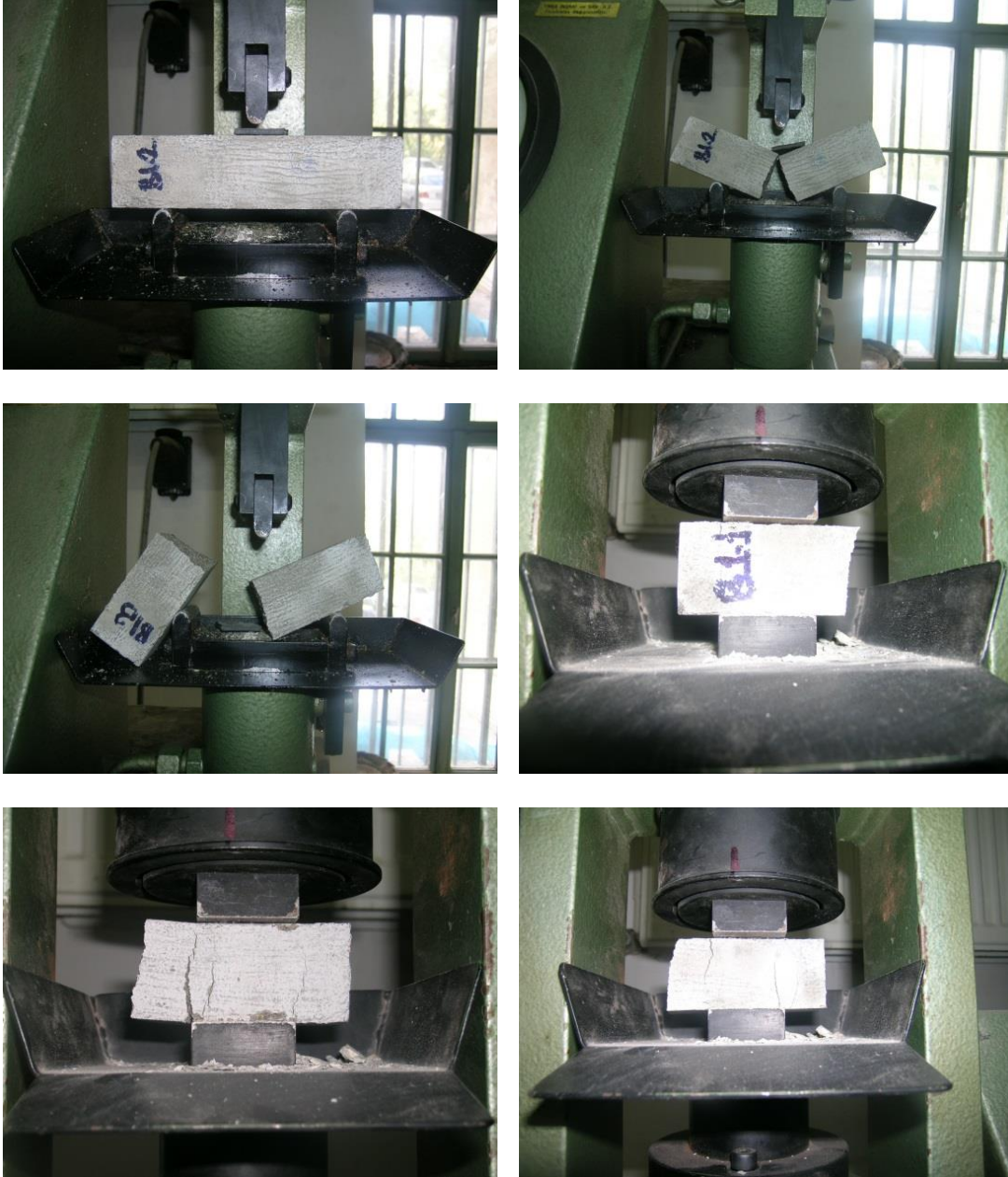
Şekil 3.8 : Çimentonun basınç ve eğilme dayanımı tayini.
