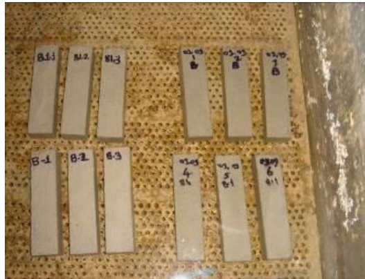
Şekil 3.9 : Çimentonun karıştırılması, kalıba yerleştirilmesi ve suda kürlenmesi.
