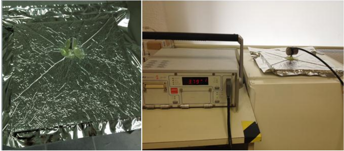
Şekil 4.37 : Basınç sensörü ile VİP iç basıncı ölçümü.
