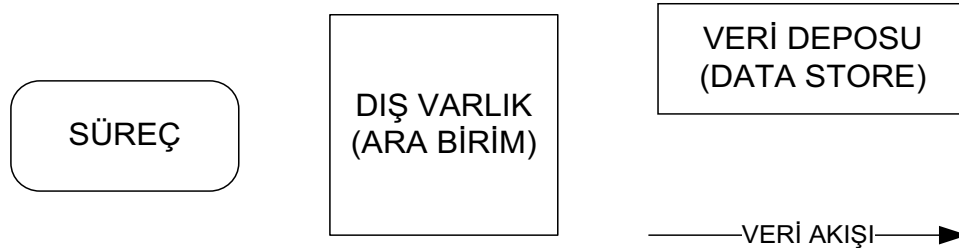
Şekil 25: Veri Akış Diyagramı Notasyonu
