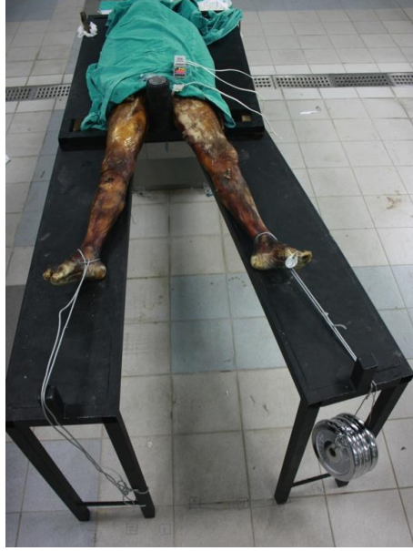
Fotoğraf 3.5. 3 numaralı (24 k ny e numaralı) kadavranın traksiyon masasına yerleřtirilmesi sonrasında pelvisin hareket etmesini  nlemek amacıyla 30° kal a abduksiyonuna sol alt ekstremiteye baėlanmıř 20 kg aėırlık asılı g r nt s 
