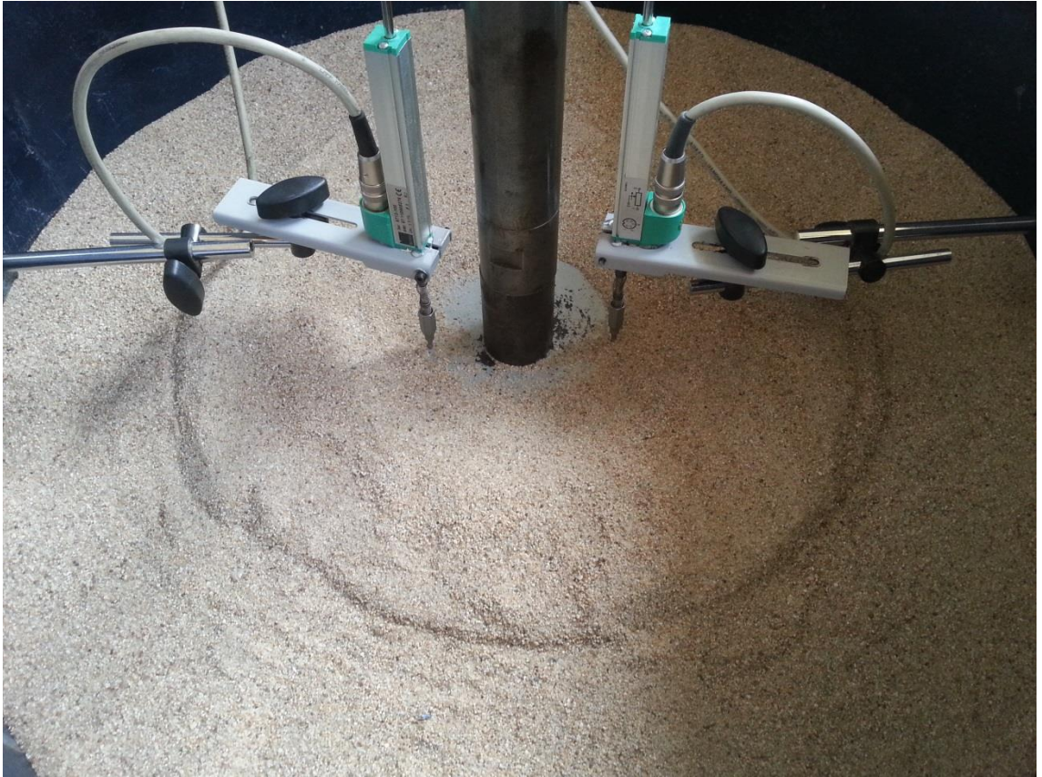
Şekil 3.16 Dr=%90 kumda meydana gelen genel göçme zarfının sınırları
