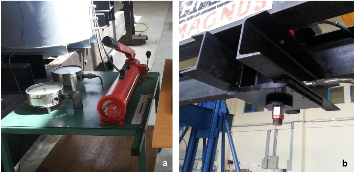
Şekil 3.10 (a) Hidrolik yük kolu ve analog yük kadranı, (b) Hidrolik başlık
