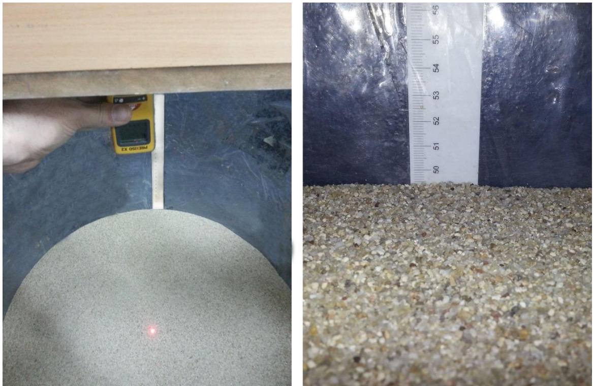
Şekil 3.6 Lazer metre ve cetvel yardımı ile tabaka kalınlığının ayarlanması
