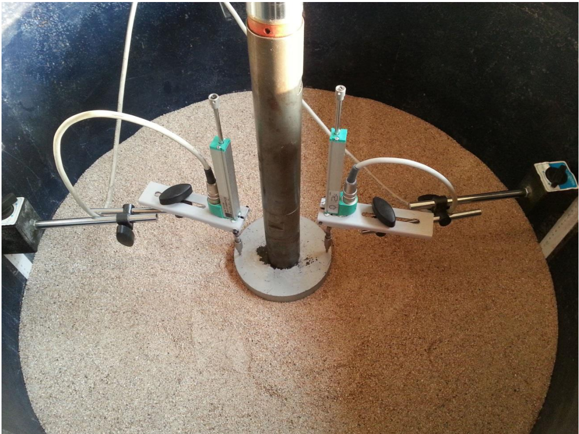
Şekil 3.11 Yükleme başlığı ve deplasman sensörlerinin yerleşim şekli
