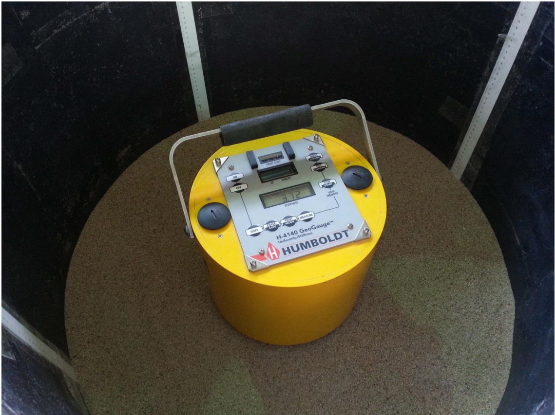
Şekil 3.4 GeoGauge ile serilen katmandan ölçüm alınması
