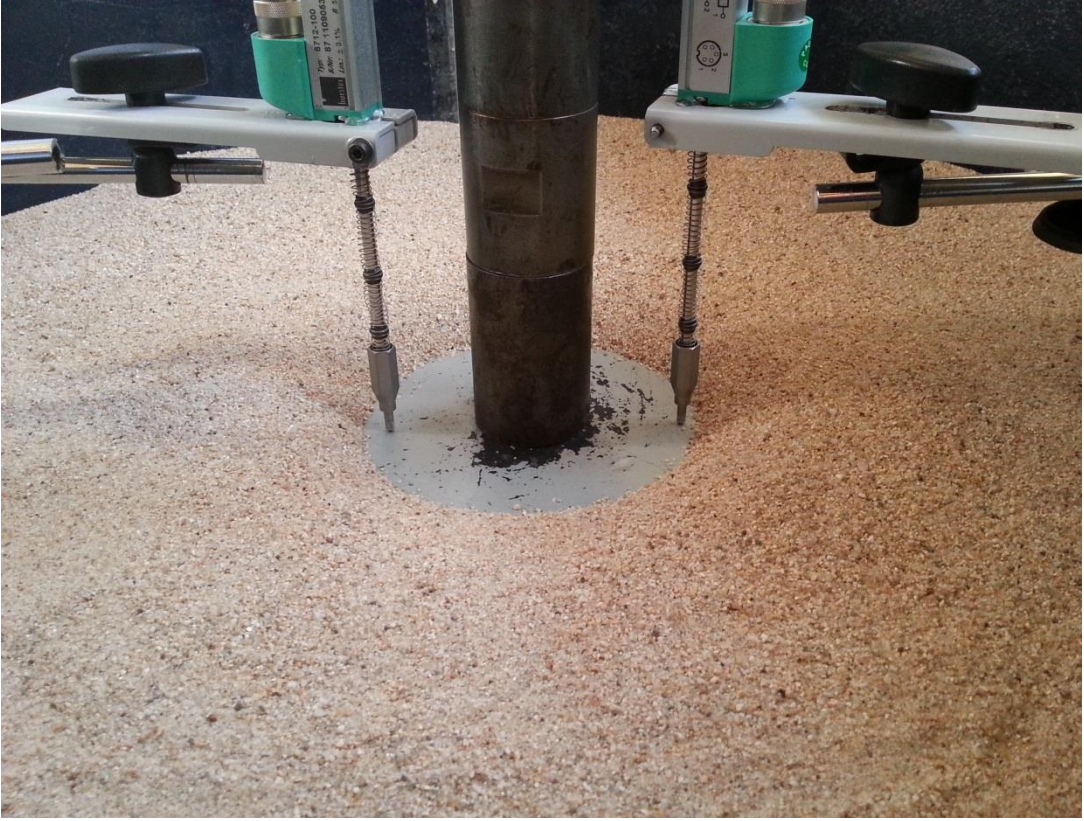
Şekil 3.14 D_r=50\% kumda meydana gelen yerel göçme zarfı ile oluşan kabarma
