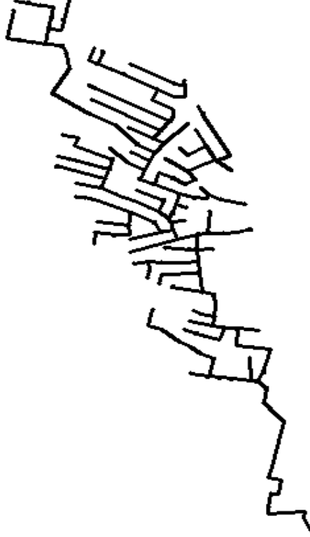
Şekil 5.3 Ağaç yapısı formunda olan bir şebeke örneği
