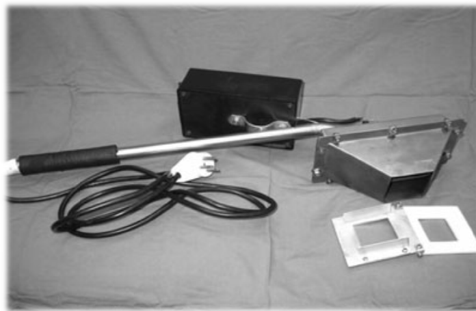
Şekil 27: Gurfinkel R ve arkadaşları nın geliştirdiği yanık oluşturma cihazı (188)
