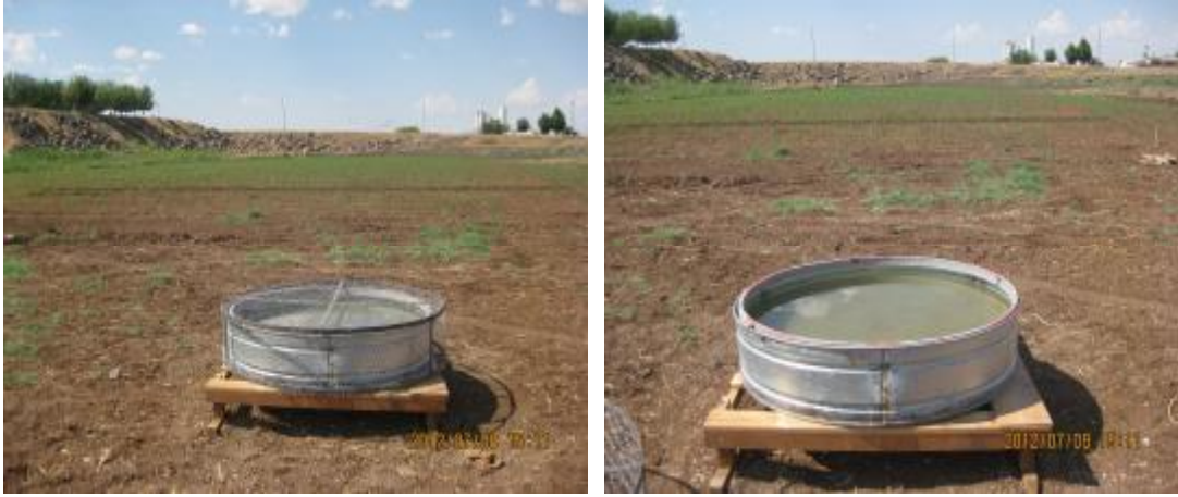
Resim 3.6. Sulama suyu miktarının hesaplanmasında kullanılan Class-A Pan
