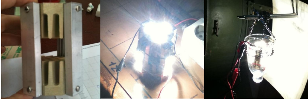
Şekil 3.14 : Çeşitli soğutucular ve LEDlerle üretilen prototiplerden örnekler.
