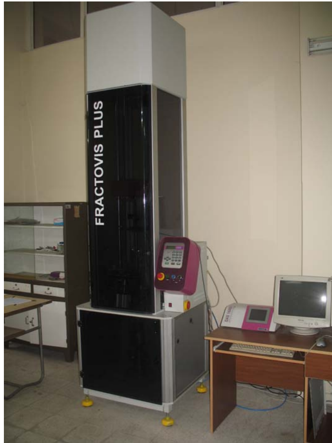
Şekil 2.6. CEAST Fractovis ağırlık düşürme darbe cihazı
