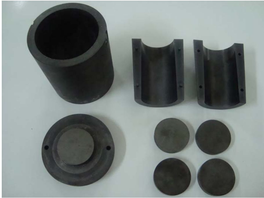
Şekil 2.5. Fonksiyonel kademelendirilmiş plaka üretimi için sıcak iş çeliğinden (AISI 2344) imal edilmiş kalıp sistemi.
