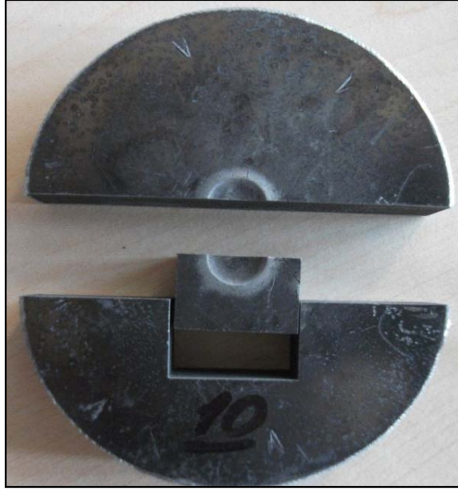
Şekil 3.20. Darbe deneyinden sonra metallografik analiz için numuneden kesit alınması.
