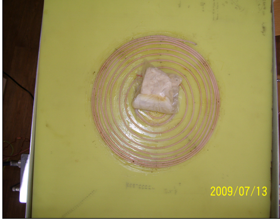
Şekil 6.21: Dış gürültünün bastırıldığı sistemde kullanılan prob.
