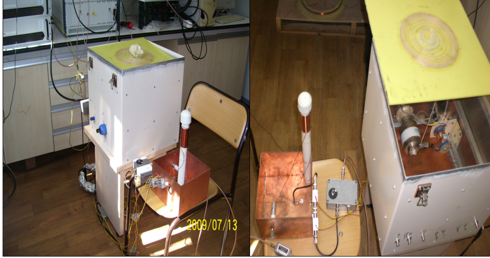
Şekil 6.19: Dış gürültünün bastırıldığı sistem, a) Patlayıcı, b) Patlayıcısız.
