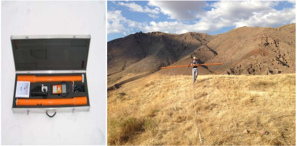
Şekil 4.5 GF Instrument EM iletkenlik cihazı ve çalışma alanından bir görüntü
