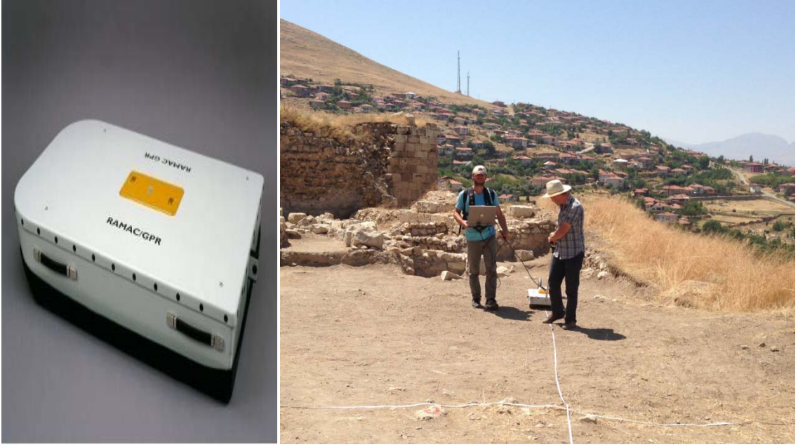
Şekil 4.4 Ramac GPR cihazı ve çalışma alanından bir görüntü
