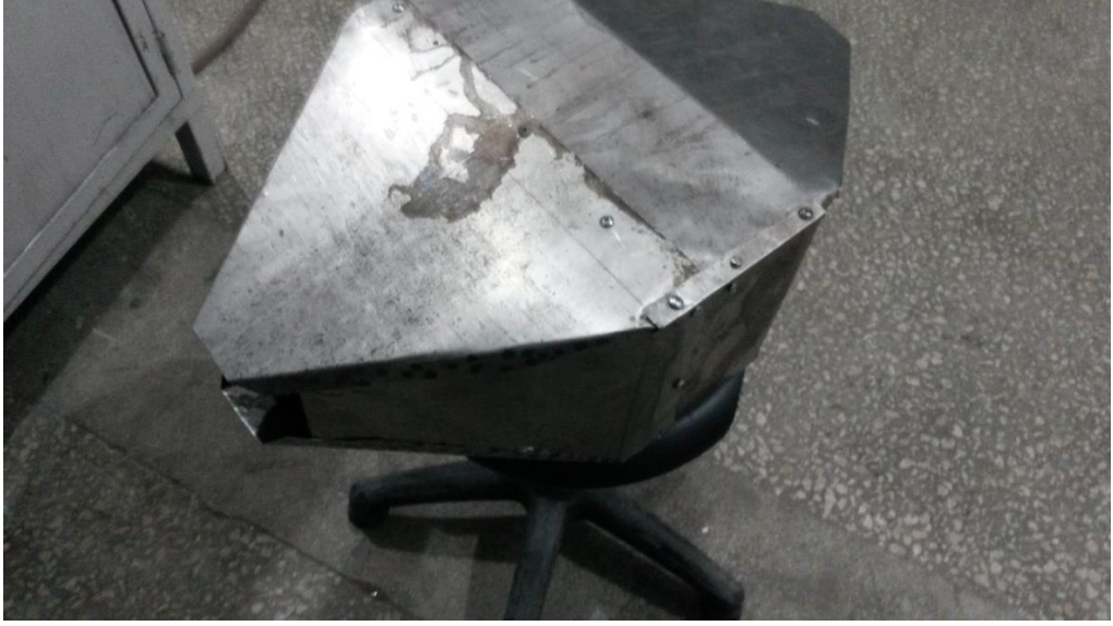
Şekil 3.8. İçerisinde ısı değıştiricisinin sabitleneceğı muhafazanın görünümü
