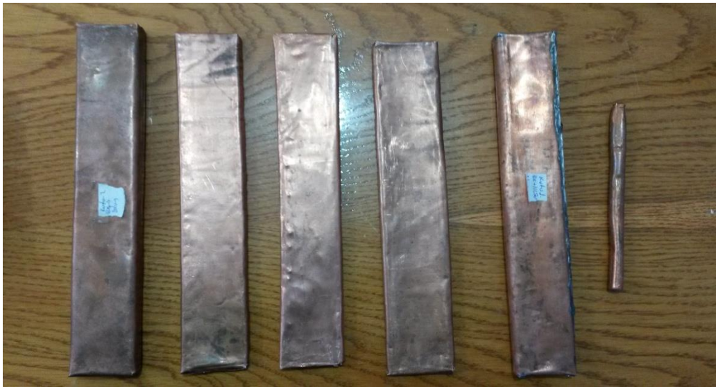
Şekil 3.7. İerisine FDM doldurulmuř bakır plakalar
