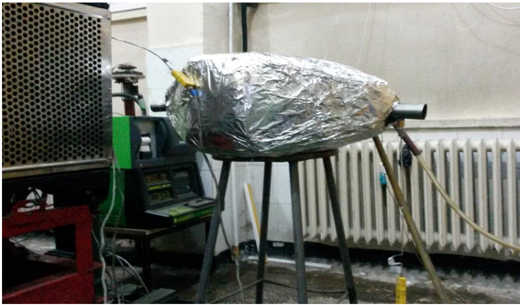
Şekil 3.12. Deney öncesi hazır hale gelen ısı değışiricisi ve muhafaza
