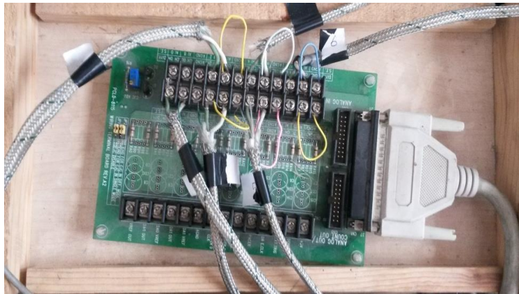
Şekil 3.16. Advantech PCL 818 HG kartı ile sıcaklık ölçümleri
